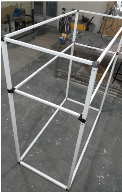
Ilustración 14. Estructura del prototipo – Unión central realizada con impresión 3D
