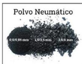
1) *Gránulo de caucho*: es la materia prima para la producción de las tejas de caucho, para la cual se utiliza una granulometría de 1,5 a 3,5 mm o 0,0/0,85 mm.
