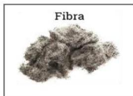
3) *Fibras*: es un material derivado del petróleo con un gran poder calorífico y con buenas propiedades de aislamiento acústico y térmico. Aún no tiene mercado.
