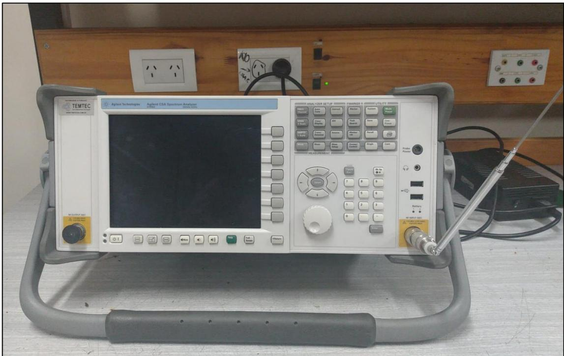
*Ilustración 14: Analizador de espectro N1996A.*
