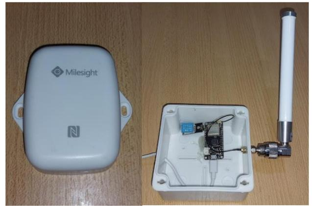
Fig. 8. Nodos LoRaWAN. A la izquierda, nodo comercial EM300-TH, a la derecha nodo implementado en laboratorio basado en una placa LoRa32u4 II.
