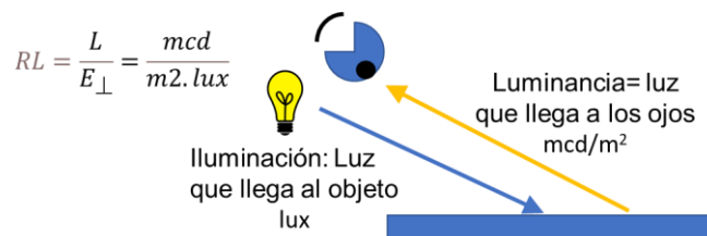
Figura 6. Definición de retrorreflexión. Fuente: elaboración propia
