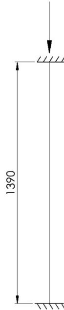
Ilustración 19. Estado de carga tramo vertical rack IBC
