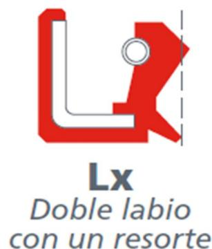
*Ilustración 54. Perfil reten columna de tolva pre mezcla*
