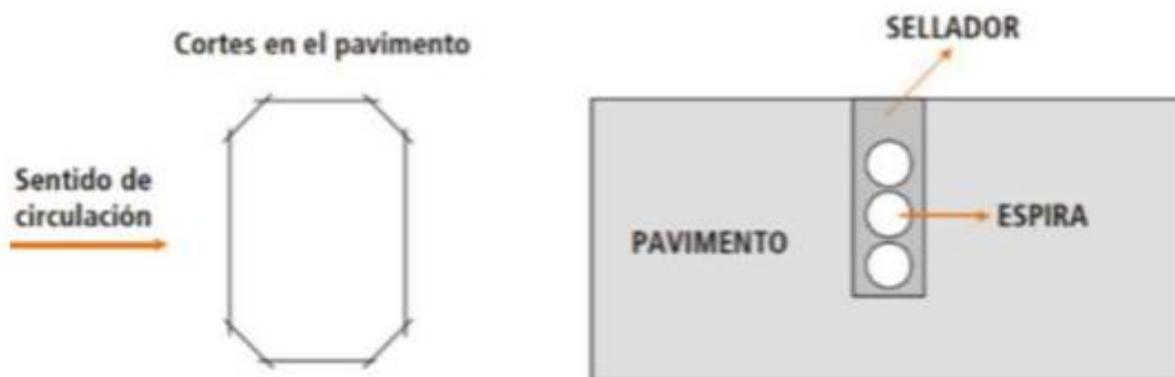
Fig. N° 65: Detalle de instalación de sellador en corte
