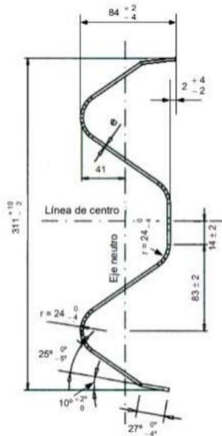
Ilustración 56 Conformado – Sección transversal defensa metálica
