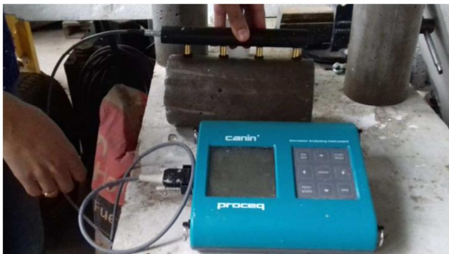
**Figura 4-1:** Medición de resistividad eléctrica en probetas cilíndricas.
