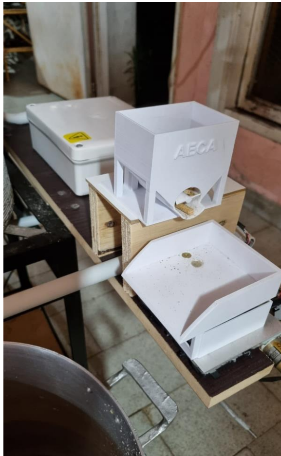
Figura 16: Sistema de dosificado
