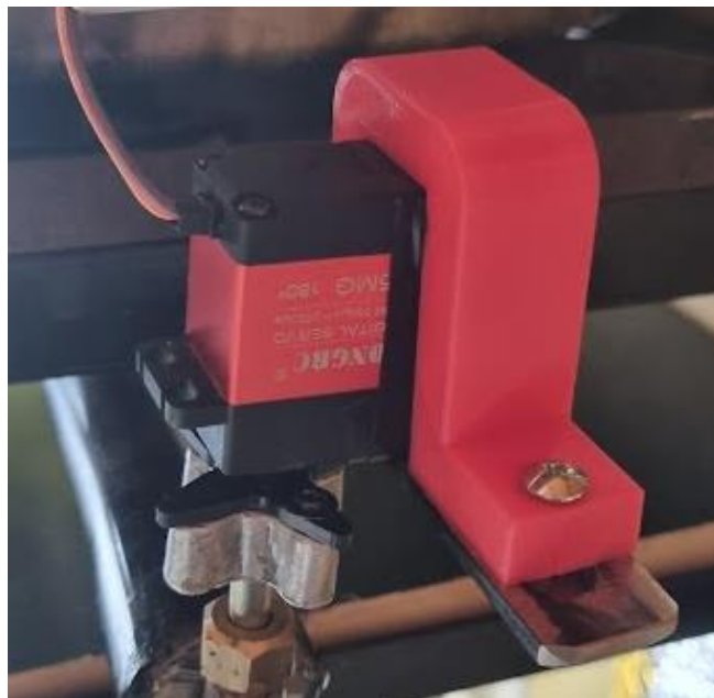
Figura 15: Sistema de control de gas
