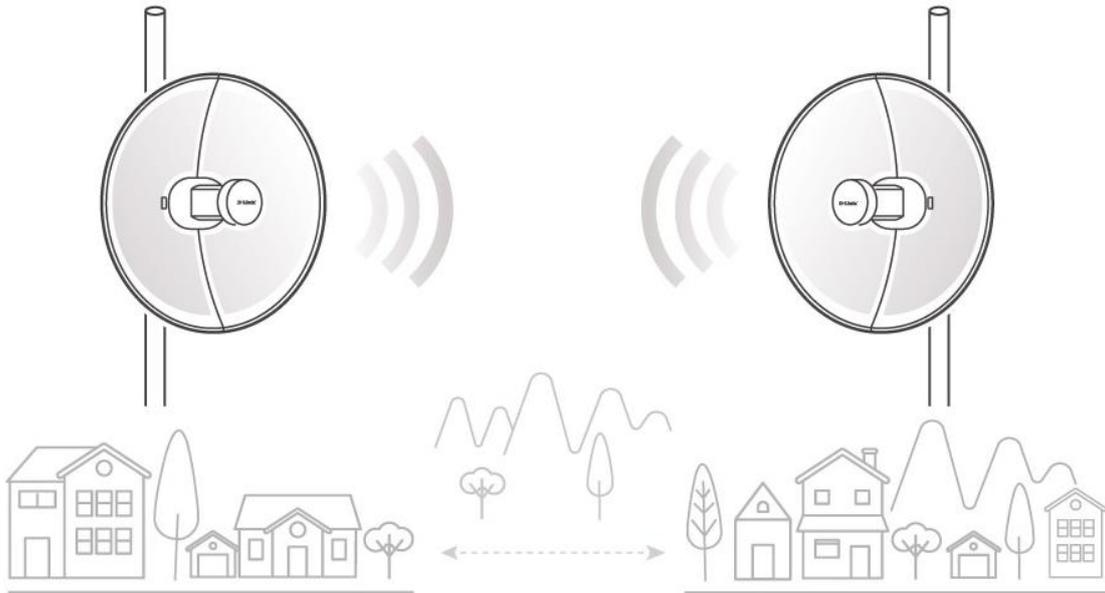
Este tipo de enlace requiere que las antenas se puedan “ver” entre ellas, es decir, que no debe haber ningún tipo de elemento que obstruya su comunicación directa, pues esto empobrecería el nivel de comunicación entre antenas, llegando incluso a interrumpir la comunicación completamente.
