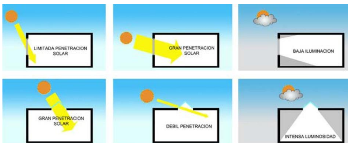
Figura 18. Penetración de luz natural cenital y lateral en invierno y verano. Fuente: (Dirección de Arquitectura del Ministerio de Obras Públicas, 2012)
