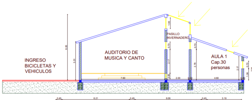
Figura 14. Corte transversal. Pasillo invernadero, aberturas cenitales de aulas. Fuente (Esteves, Flores Cáceres, Esteves, & Esteves, 2013)
