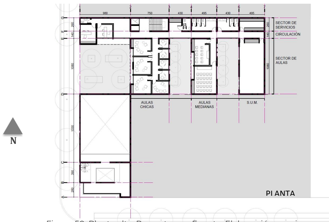
Figura 50. Planta alta. Proyecto arq. Fuente: Elaboración propia
