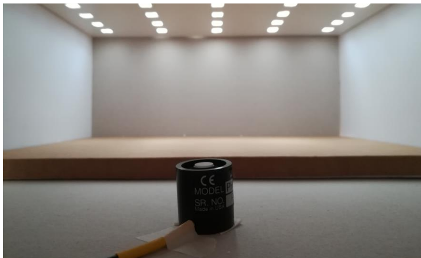
Figura 58. Luxímetro en punto de medición. Fuente: Elaboración propia
