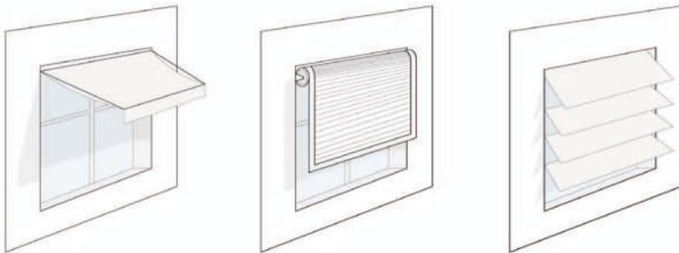
Figura 35. Protecciones solares móviles. Fuente: (Dirección de Arquitectura del Ministerio de Obras Públicas, 2012)
