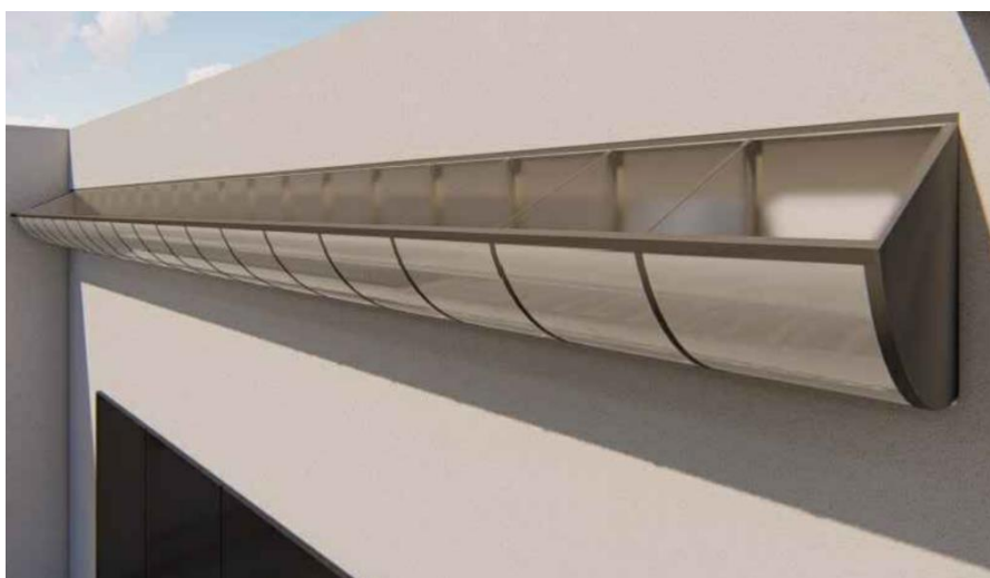
Figura 95. Corte Auditorio. Sistema anidolico simple. Fuente: Elaboración propia
