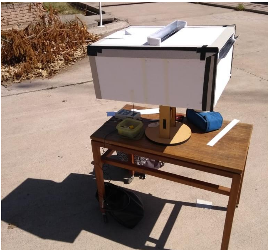
Figura 55. Modelo a escala sobre heliodón. Fuente: Elaboración propia
