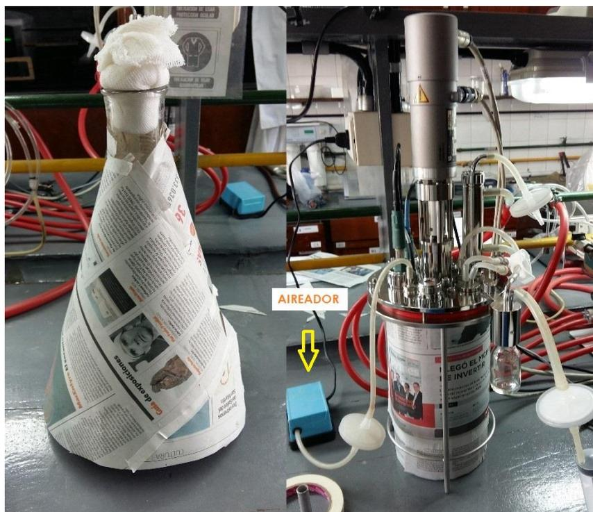
Figura II - 19: Biorreactores en régimen de oscuridad total, al momento de iniciar la incubación.
