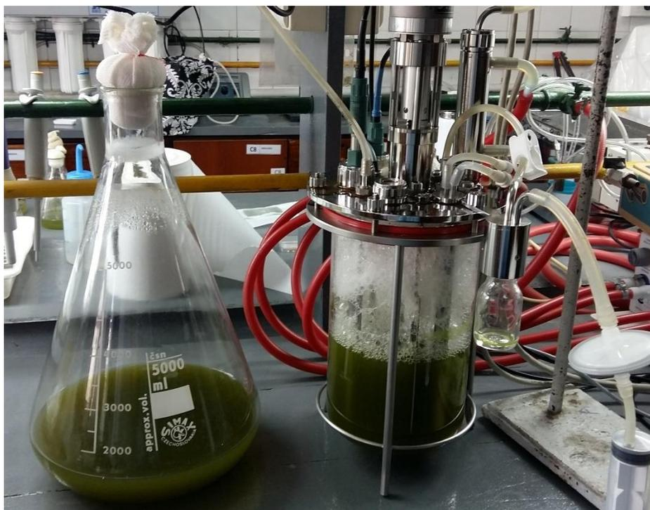
Figura II - 22: Biorreactores al final del período de cultivo, al momento de la cosecha final de biomasa.
