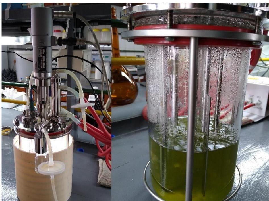
Figura III - 25: Biorreactor tanque agitado con cultivo de *S. quadricauda*. Imágenes tomadas durante la incubación y toma de muestras.
