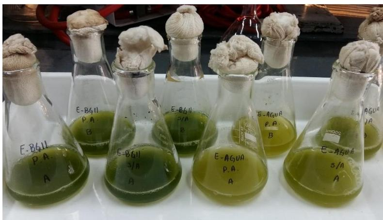
Figura III - 10: Sistemas incubados en efluente con diluyente agua y BG11, con inóculos pre-adaptados y sin adaptar; a los 7 días de incubación.
