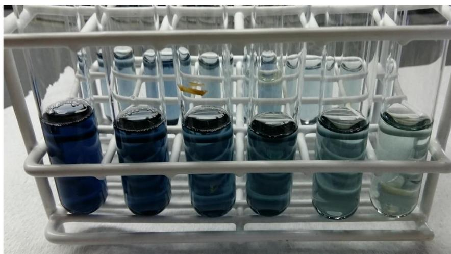
Figura II - 5: Imagen de las muestras de estándar de SAB finalizado el tratamiento según el método de Lowry
