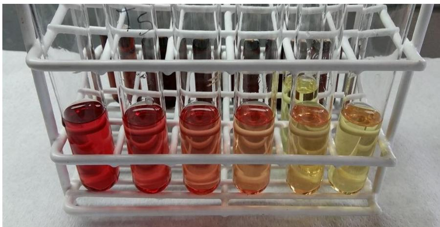
Figura II - 4: Imagen de las muestras de estándar de aceite de canola finalizadas las reacciones del método SFV.
