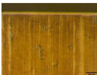
Fig.1 Micrografía óptica capa nitrurada 200x
