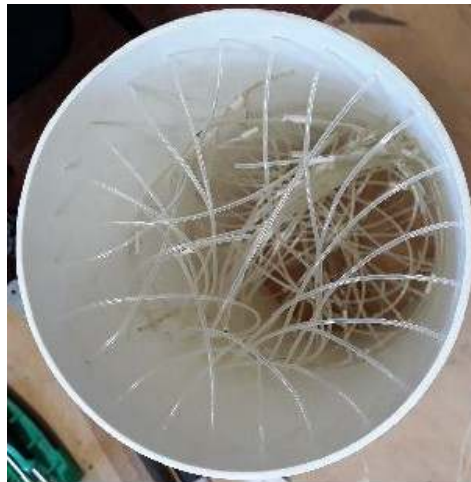
Figura 3: salida de tubos de presión para toma de datos (Fuente: Wittwer et al. , 2020)
