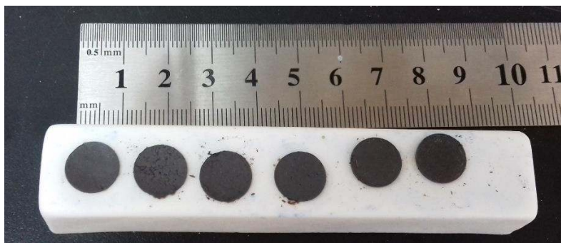
Figura 1. Pastillas de LSGM prensadas y tratadas térmicamente.
