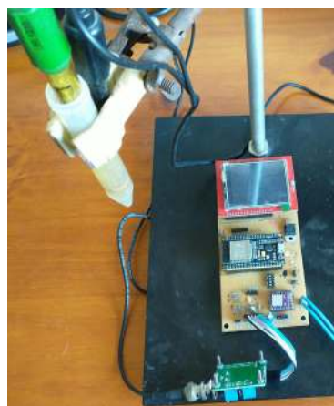
Fig. 2. Montaje del prototipo de prueba para la calibración.
