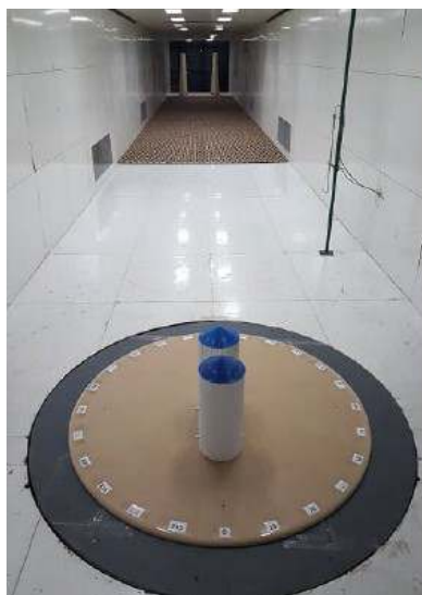
Figura 1: modelos sobre la mesa de ensayo en el túnel de viento Jacek Gorecki (UNNE)
