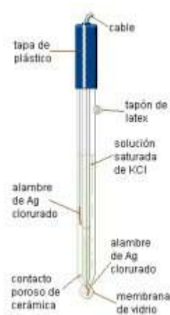
Fig. 1. Electrodo combinado de pH de Ag/AgCl. [2]
