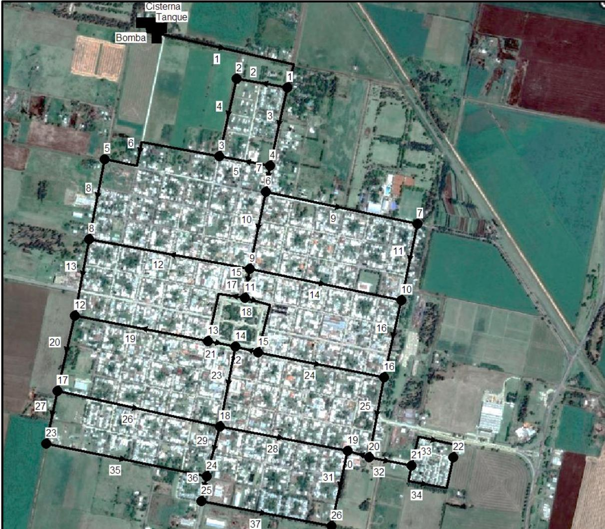
Figura 3.14: Trazado de la red de cañerías principales. (Fuente: Elaboración propia)
