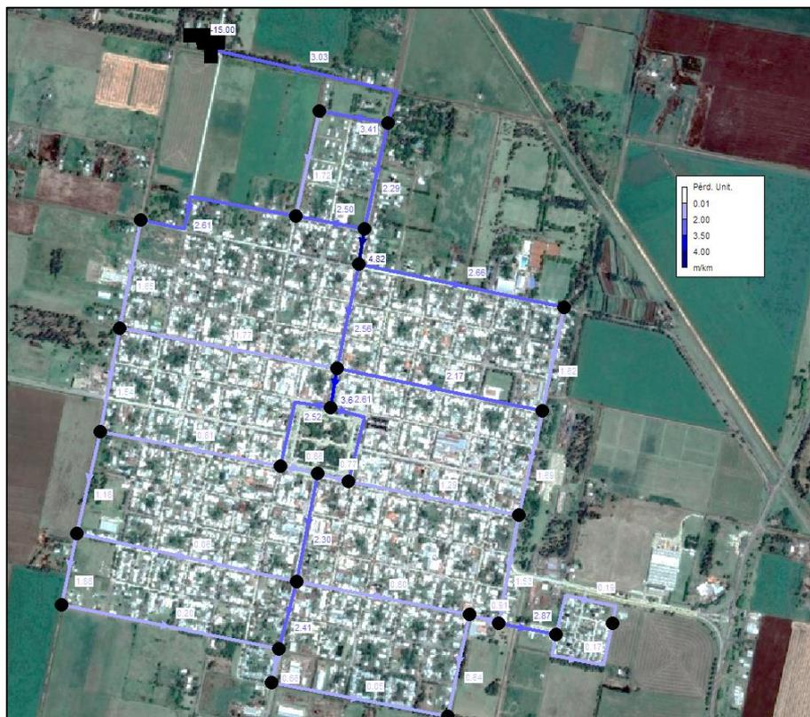
**Figura 3.16:** Pérdida de carga máxima en las conducciones. (Fuente: Elaboración propia)
