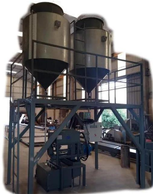
Ilustración 56: Planta de desgomado
