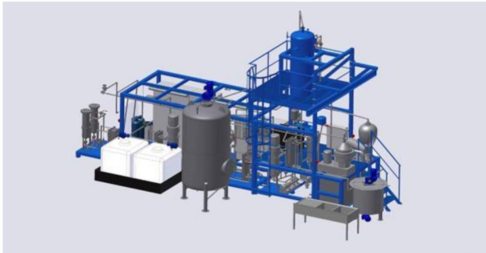
Ilustración 62: Planta de refinado<sup>20</sup>
