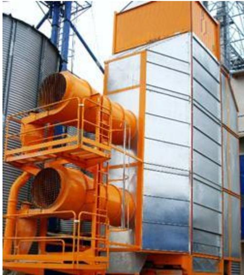
Ilustración 43: Secadora de semillas
