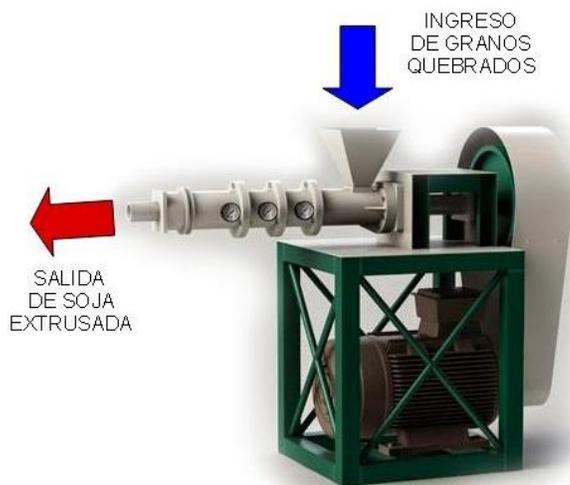
Ilustración 48: Extrusora<sup>11</sup>
