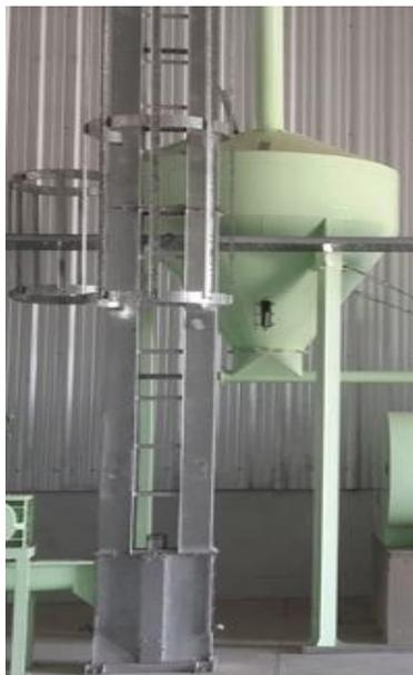
Ilustración 47: Depósito pre extrusado
