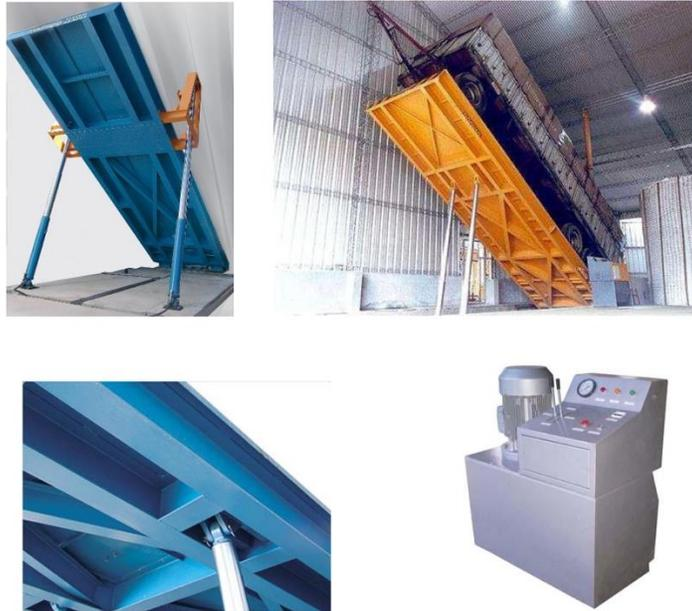
Ilustración 35: Plataforma volcadora<sup>9</sup>
