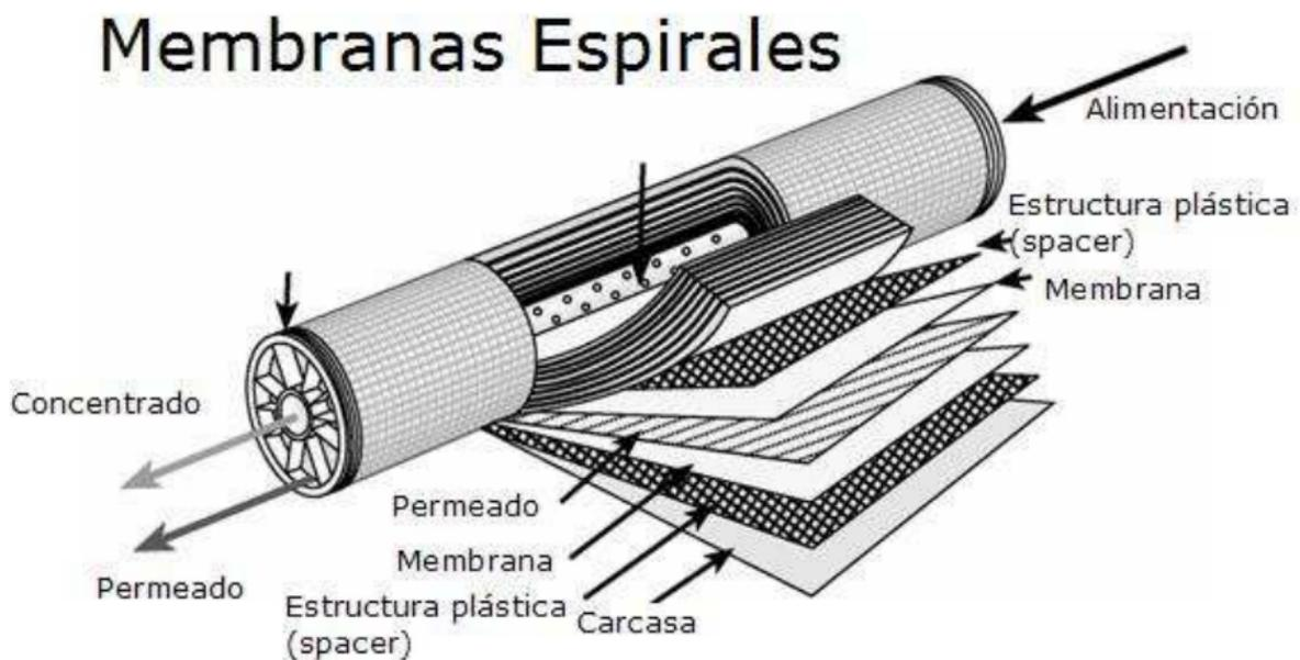
Figura 1.4. Membrana para osmosis inversa.
