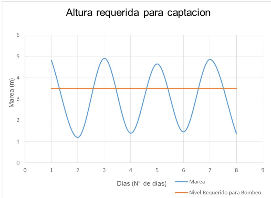
Figura 2.7. Gráfico Nivel requerido para captación
