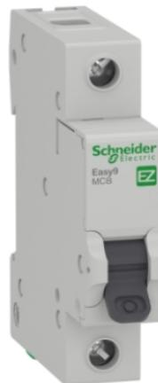
Figura 5.86 Interruptor termomagnético Easy9 1P 6A 4,5kA curva C
