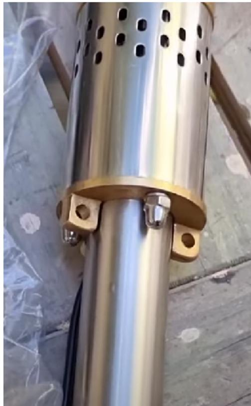
Figura 5.51. Ojal de electrobomba para cable de acero
