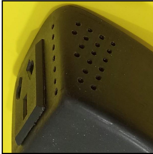
Figura 77. Perforaciones en la esquina donde se ubica el sensor.
