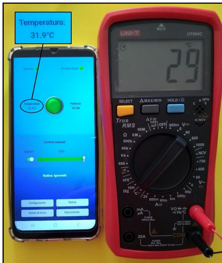
Figura 79. Ensayo de temperatura, con carga.
