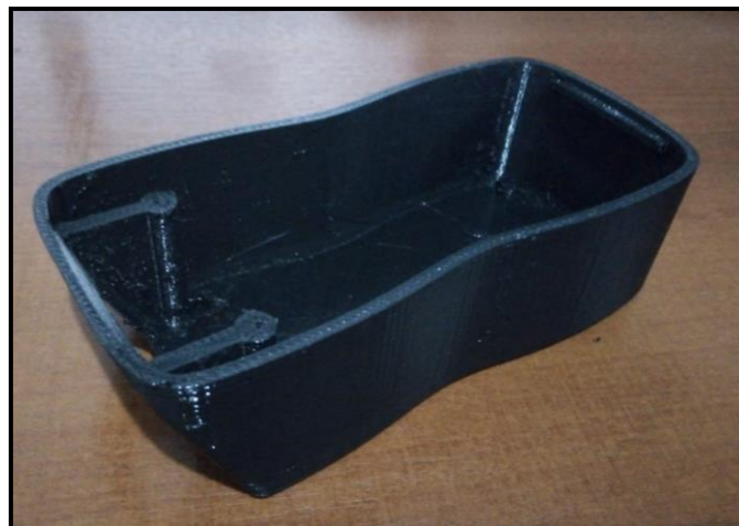
Figura 65. Impresión 3D de la base sin procesar.
