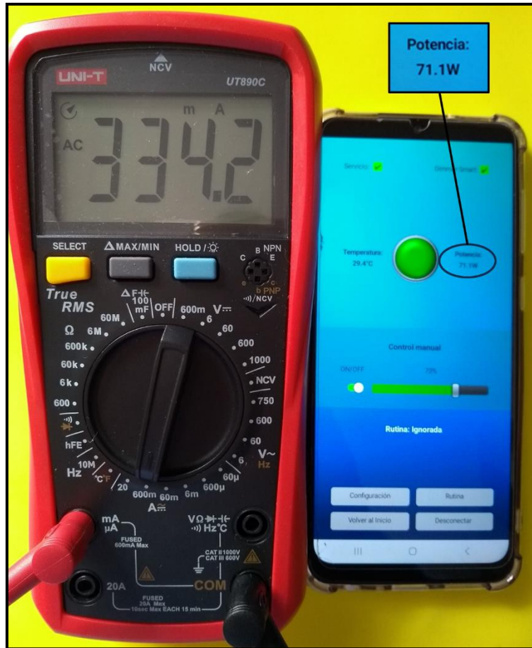
Figura 80. Medicion de corriente, para contraste de potencia
