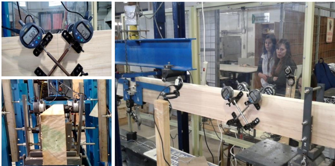
Figura 4: Ensayo a flexión con determinación de módulo G
