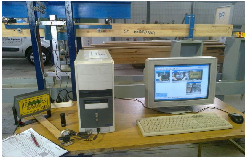
Figura 3: Equipamiento para captura por cámaras Web
