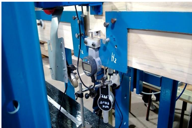
Figura 2: Dispositivo de medición de las deformaciones
