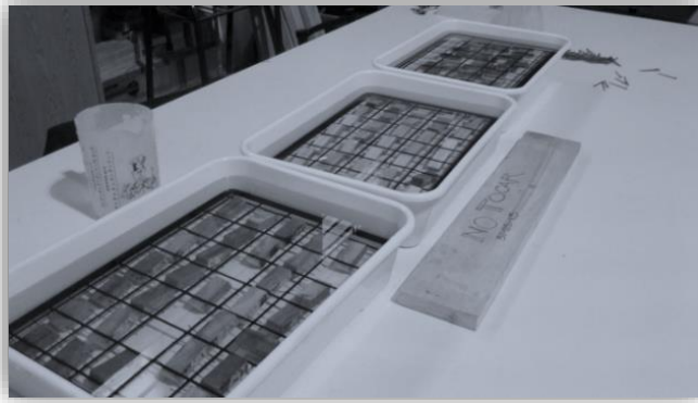
Figura 3. Probetas inmersas en agua para la saturación de las fibras
