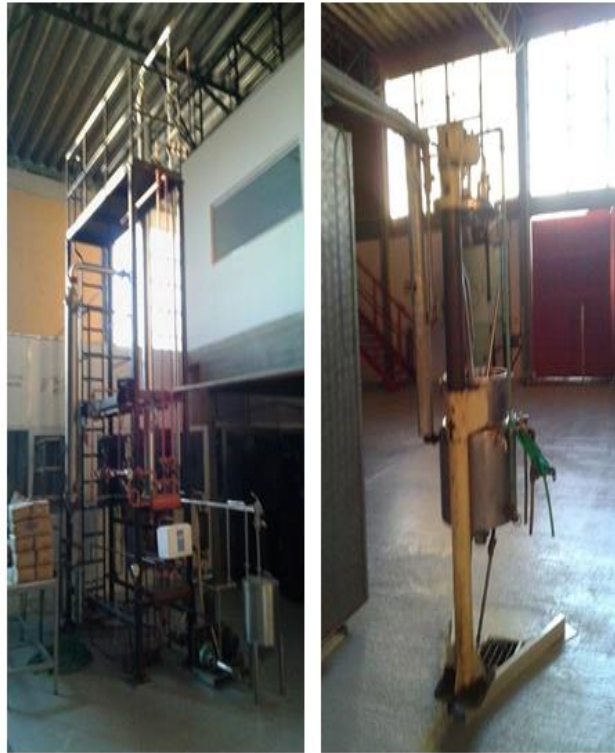
Figura 5: Paila y evaporador de jugo.
