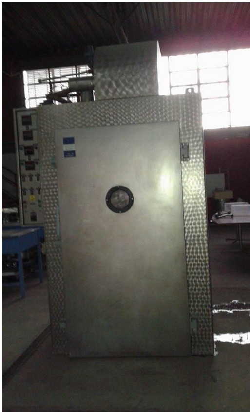
Figura 11: Vista frontal de secador de Chacinados, sin instalar.
