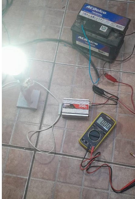
Ilustración 46- Conexión del inversor a la batería
