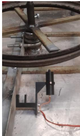
Ilustración 45- Medición de rpm en la polea que se encuentra en el eje de la turbina
