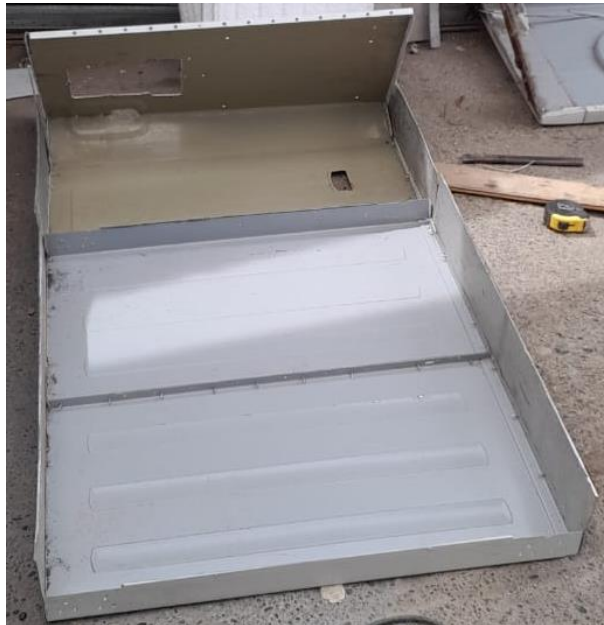
Ilustración 37- Base de chapa para el poliestireno expandido
