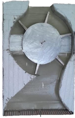
Ilustración 34- Base con turbina, maya y estructura con poliestireno expandido (vista superior)
