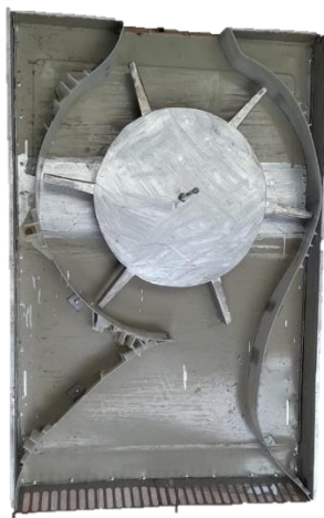
Ilustración 33- Base del prototipo con la turbina y el circuito del agua
