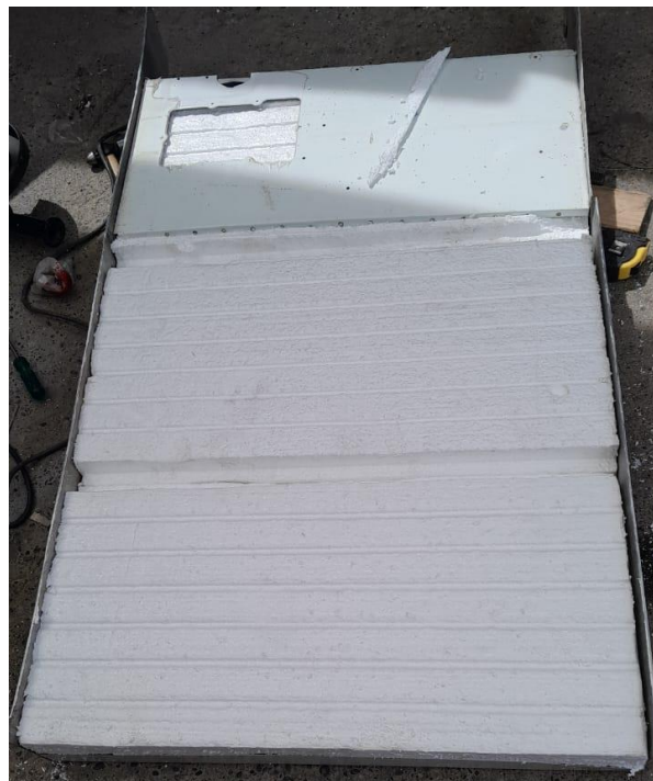
Ilustración 38- Base de chapa con poliestireno expandido
