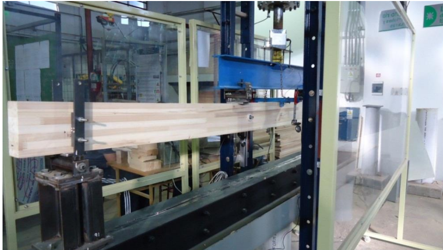
Figura 3. Ensayo de viga laminada a flexión
