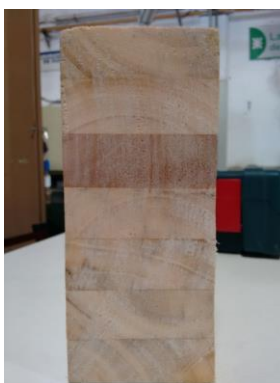
Figura 1. Corte de viga laminada.
