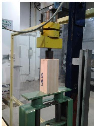
**Figura 3: Ensayo para obtener el valor de la Dureza Longitudinal**
