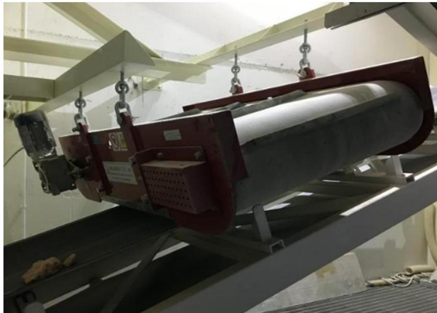
*Ilustración 163 Disposición transversal de cinta magnética*
