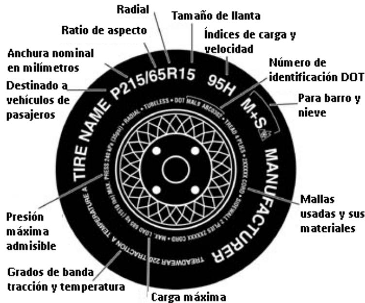
*Ilustración 4 Características de un Neumático*
