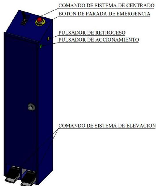
*Ilustración 109 Columna de Accionamiento*
