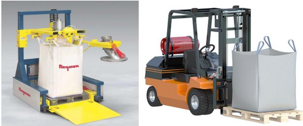
*Ilustración 117 Modo de extraer y transportar el Big Bag*
