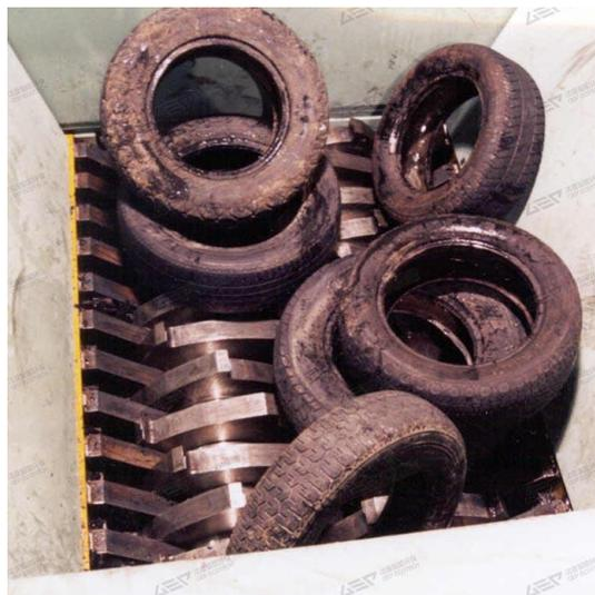
*Ilustración 20 Vista Superior Tolva Mod. 2 trituradora*
