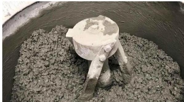
*Ilustración 9 Utilización del Caucho en hormigón*
