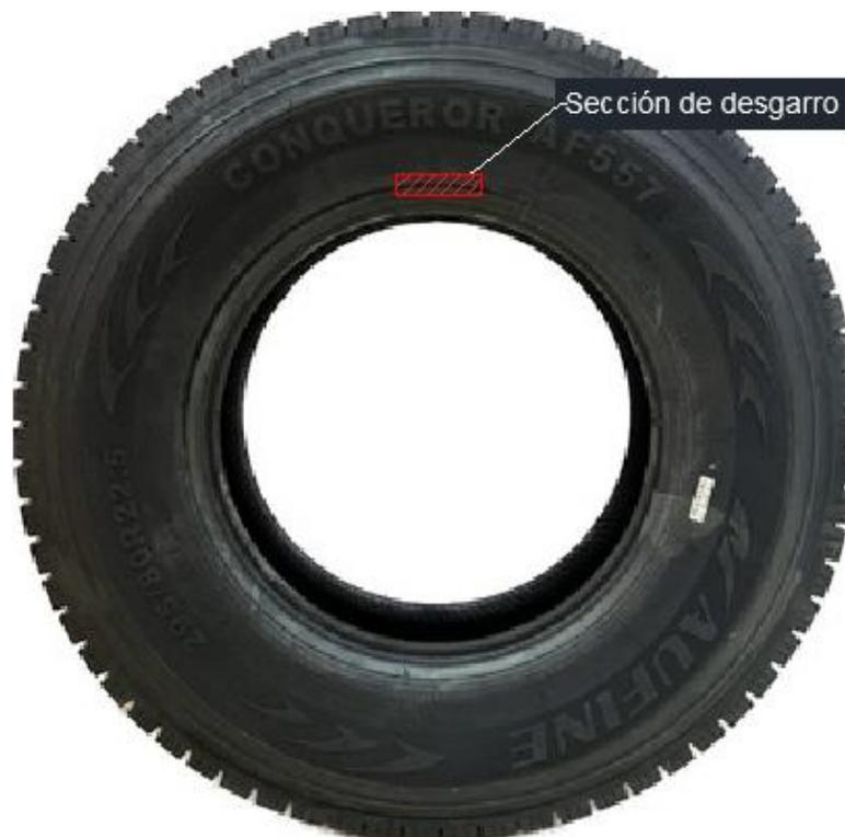
*Ilustración 37 Representación de Sección de Desgarro*
