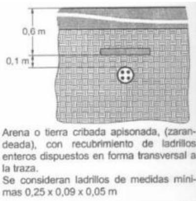
*Ilustración 290 Condiciones Conductor Enterrado*
