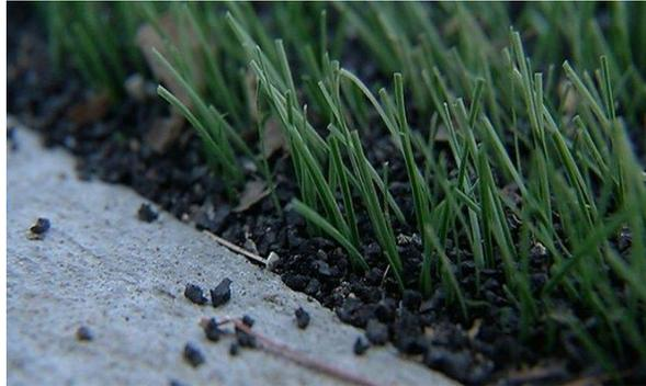
*Ilustración 7 Caucho en Césped Sintético*
