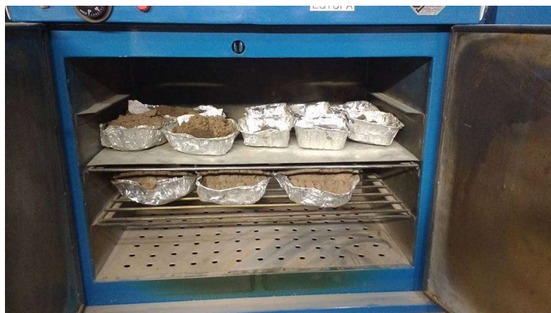
Figura 45 – Muestras de suelos en estufa de laboratorio de suelos de UTN-FRVT
