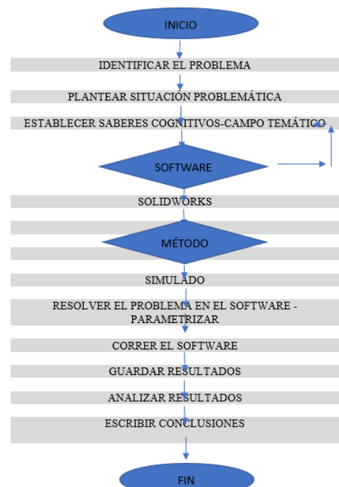
Figura 2: Algoritmo para la aplicación del software SolidWorks para modelado numérico y simulación.
