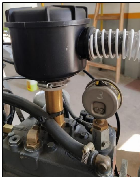
Figura 28: Toma de aire filtrada modificada. Fuente: Fotografía tomada en la empresa.
