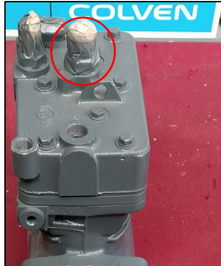
Figura 27: Cabezal del compresor restaurado KNORR-BREMSE LP49. Fuente: Fotografía tomada en la empresa.
