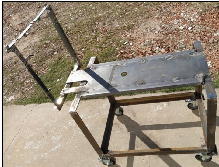
Figura 68: Resultado de la fabricación primitiva del armazón de la Unidad de Ensayo. Fuente: Fotografía tomada en la empresa.
