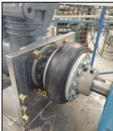
Figura 15: Acoplamiento directo. Fuente: Fotografía tomada en la empresa.
