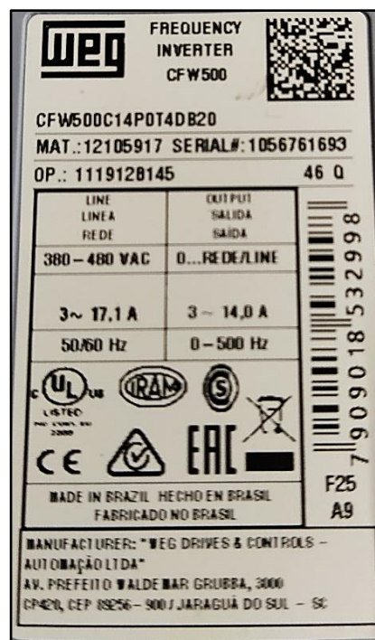
Figura A.9: Placa de datos característicos del inversor de frecuencia CFW500.
