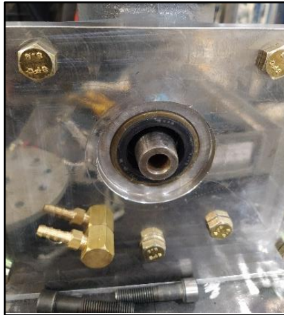
Figura 17: Placa de sujeción del compresor. Fuente: Fotografía tomada en la empresa.
