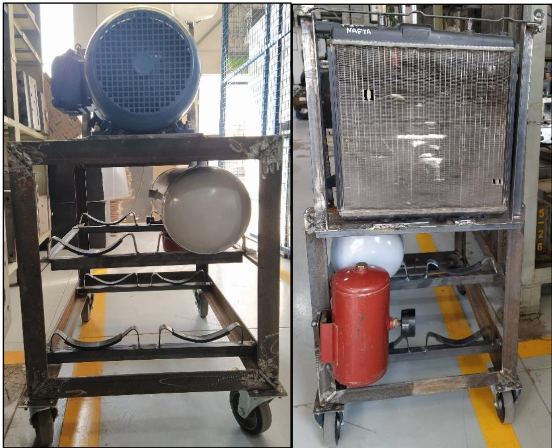
Figura 18: Vistas de la estructura metálica de soporte y alojamiento de los sistemas neumático, eléctrico, de lubricación, de refrigeración y de transmisión mecánica. Fuente: Fotografía tomada en la empresa.
