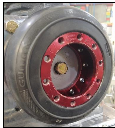
Figura 16: Unión bridada amortiguada. Fuente: Fotografía tomada en la empresa.
