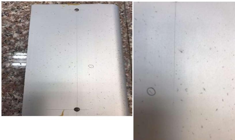
**Figura 3.20.** Probetas de aluminio anodizado expuestas en la zona atmosférica.
