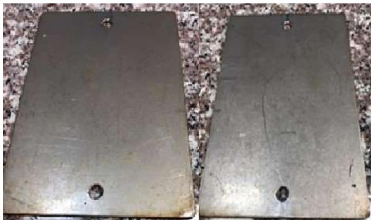
**Figura 3.21.** Probetas de acero inoxidable AISI 304 expuestas en la zona atmosférica.
