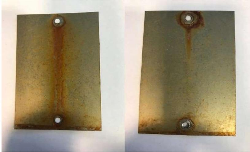
**Figura 3.31.** Aspecto superficial de las probetas de acero inoxidable AISI 304 expuestas en la zona intermareal del muelle Luis Piedra Buena.
