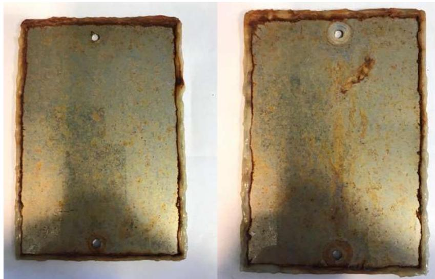
**Figura 3.32.** Aspecto superficial de las probetas de acero inoxidable AISI 430 expuestas en la zona intermareal del muelle Luis Piedra Buena.
