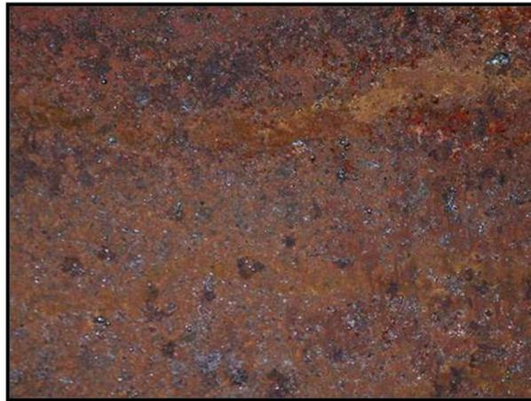
**Figura 3.2.** Aspecto superficial de la pared interna de un tubo de agua para calefacción con corrosión generalizada (fotografía de Ana Julia Lifschitz).
