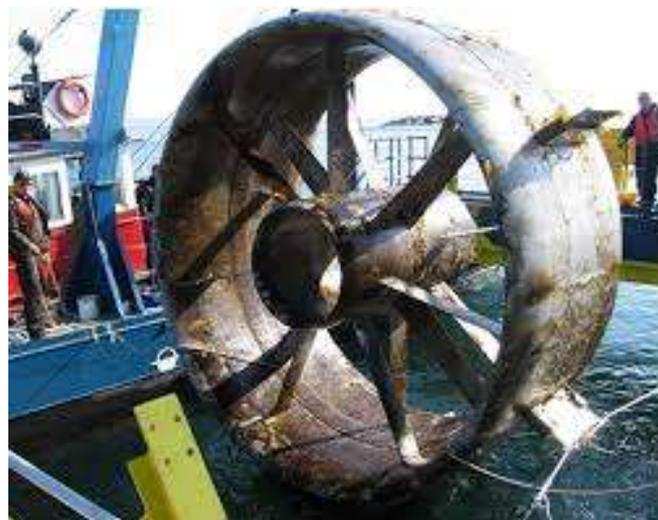
**Figura 3.8.** Depósitos orgánicos en una hélice de turbina de marea (Song *et al.*, 2019).
