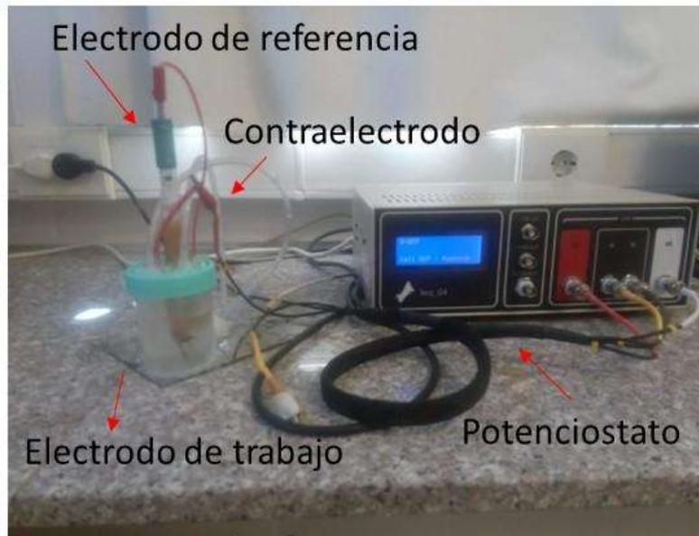
**Figura 3.10.** Laboratorio UTN FRCH: Potenciostato y celda electroquímica integrada por un electrodo de referencia de Ag/AgCl, y un contraelectrodo de Pt, utilizados en las medidas de resistencia a la corrosión de los materiales de estudio (electrodo de trabajo).
