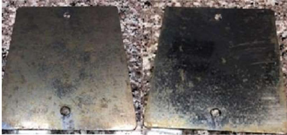
**Figura 3.22.** Probetas de acero AISI 430 expuestas en la zona atmosférica.
