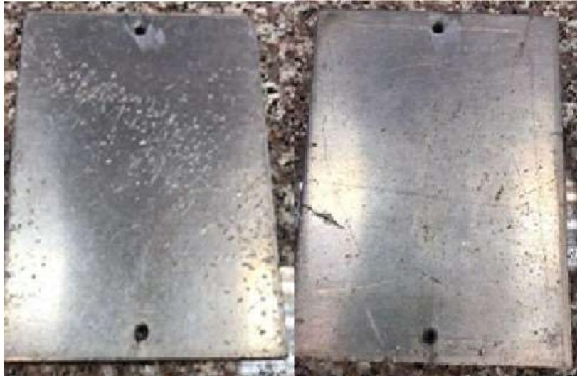
**Figura 3.19.** Probetas de aluminio 1370 expuestas en la zona atmosférica.
