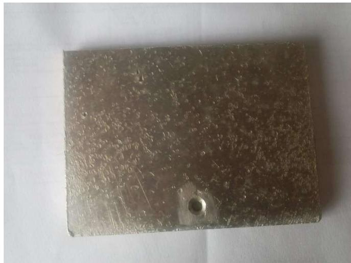
**Figura 3.28.** Aspecto superficial de las probetas de aluminio 1370 expuesta en la zona intermareal del muelle Luis Piedra Buena.
