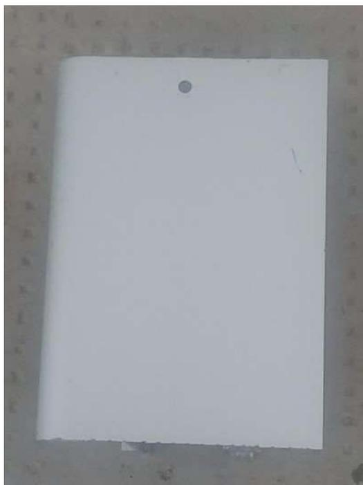
**Figura 3.29.** Aspecto superficial de la probeta de aluminio anodizado expuesta en la zona intermareal del muelle Luis Piedra Buena.
