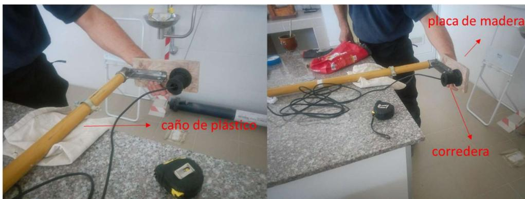
**Figura 1.9.** Fotos del dispositivo utilizado en las mediciones de velocidad en Río Chubut.
