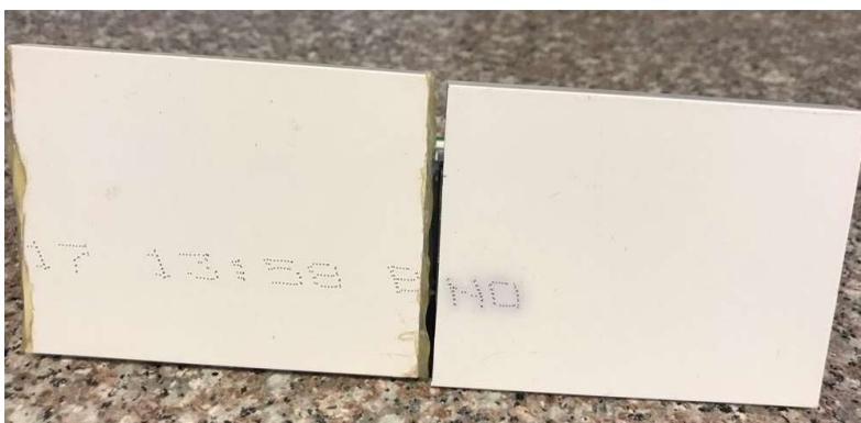
**Figura 3.30.** Aspecto superficial de las probetas de aluminio anodizado con un revestimiento orgánico expuestas en la zona intermareal del muelle Luis Piedra Buena.
