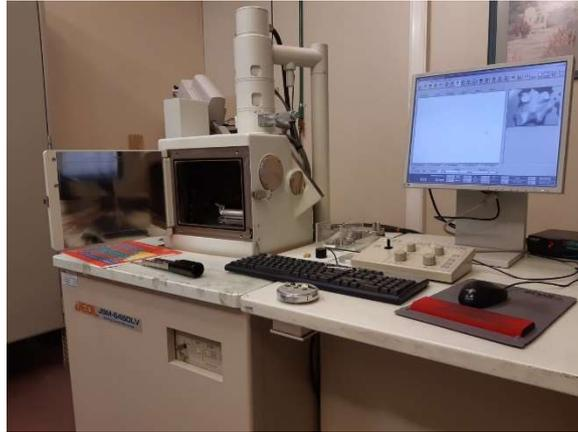
**Figura 3.14.** Laboratorio de microscopía donde se efectuaron los estudios utilizando microscopía electrónica de barrido, empresa ALUAR.
