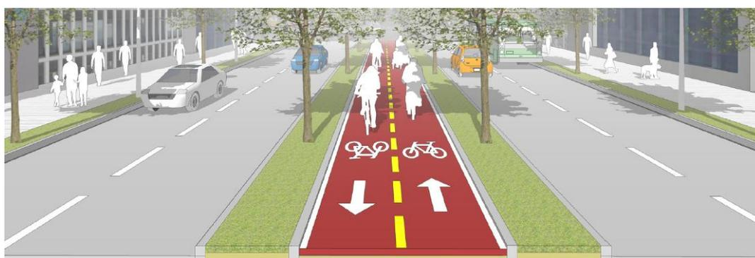
Figura 3.3.D. - Ejemplo esquemático de ciclovia (bidireccional) en separador central. Fuente: Manual de Lima (2017)-
