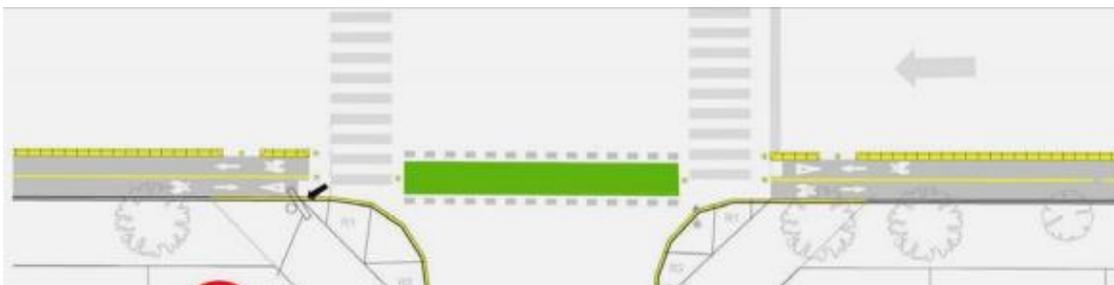
Figura 3.4.N. - Imágenes preformadas- distribución. Fuente: Lineamientos generales Ciclovías y Bicisendas. Ministerio de Transporte Argentina
