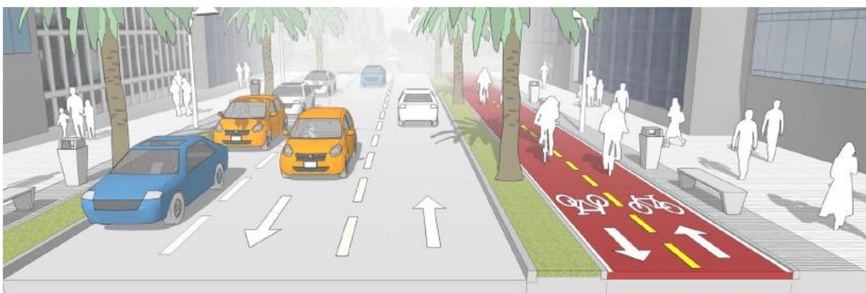
Figura 3.3.F. - Ejemplo esquemático de bicisendas bidireccional. Fuente: Manual de Lima (2017)-
