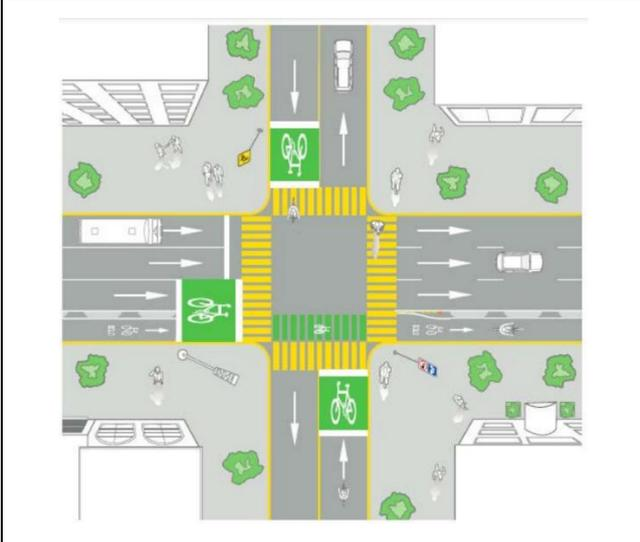
Figura 3.5.E. – Intersección tipo de una vialidad con ciclovia unidireccional
