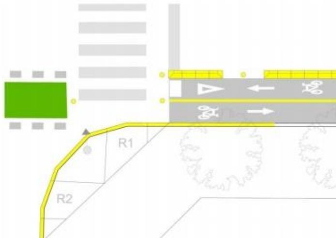
Figura 3.4.P. - Ubicación de delineadores en esquina. Fuente: Lineamientos generales Ciclovías y Bicisendas. Ministerio de Transporte Argentina
