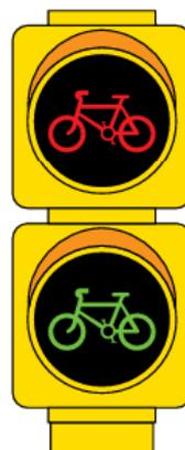
Figura 3.4.S – Esquema de semáforo para ciclista. Fuente: Manual integral de movilidad ciclista para ciudades mexicanas, 2021.
