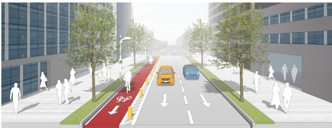
Figura 3.3.C. - Ejemplo esquemático de ciclovia unidireccional. Manual de Lima (2017)-
