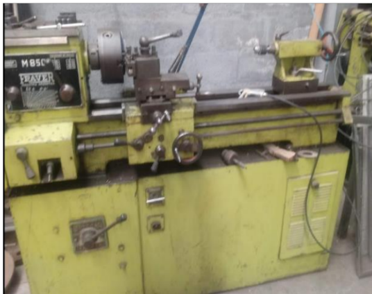
Imagen N° 6 Torno del taller sin protección (foto real tomada con la cámara del teléfono)
