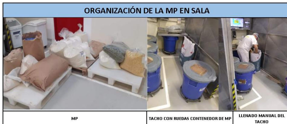
Figura 4. Vista de acopio de materia prima y llenado manual de tacho.
