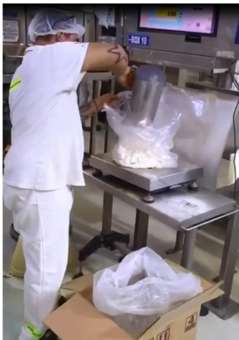
Figura 10. Puesto de pesaje de materia prima y formación de batch. Miembro superior pronado
