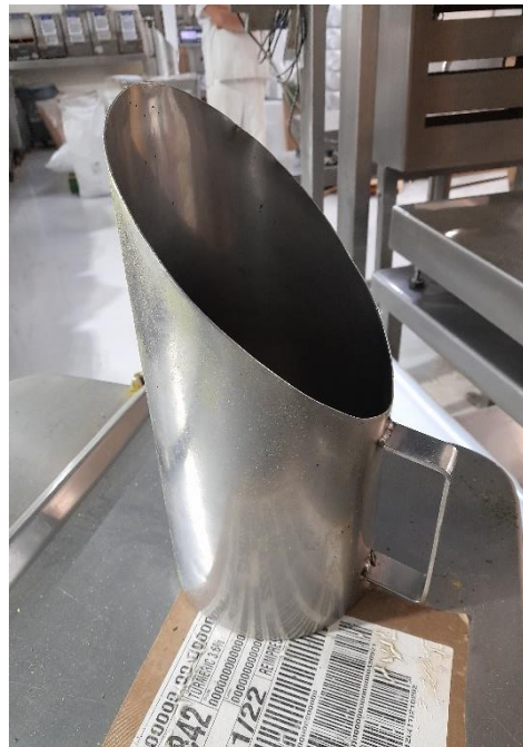
Figura 11. Jarra de acero inoxidable 2,5 kg utilizada para el llenado de bolsas
