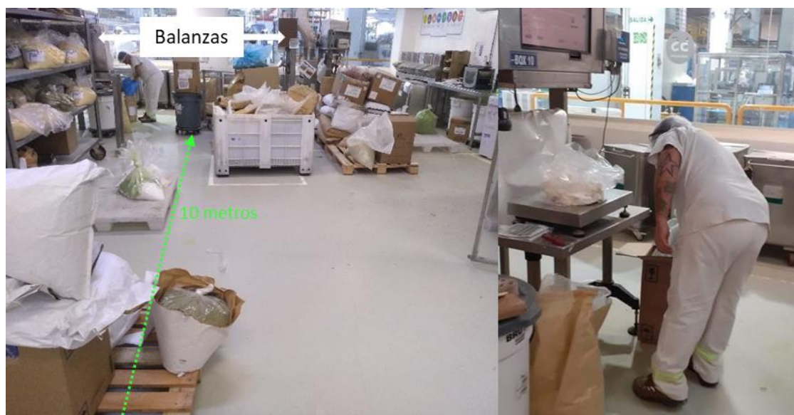
Figura Izq. Vista general de sala de especias, ubicación de pallets con materia prima y la distancia de los mismos a la zona de balanzas. Der. Acopio de producto en balanza y vista de contenedores al fondo.
