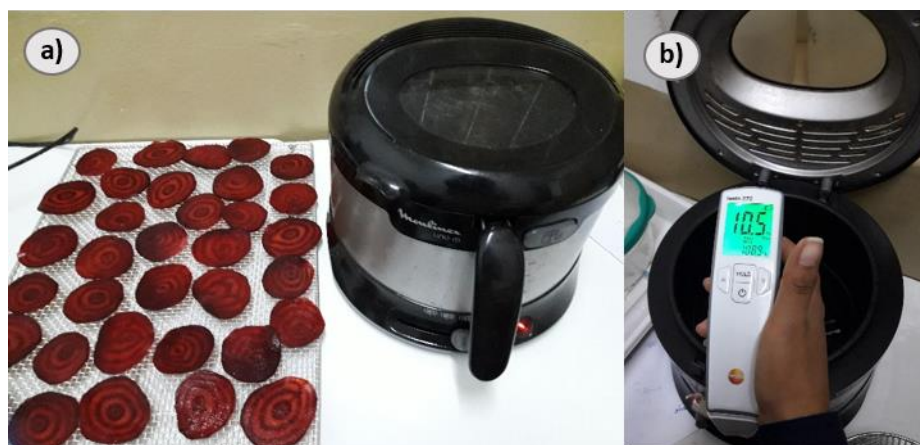
Figura 24. Equipos utilizados para la fritura (a) y medición de TPM (b).
