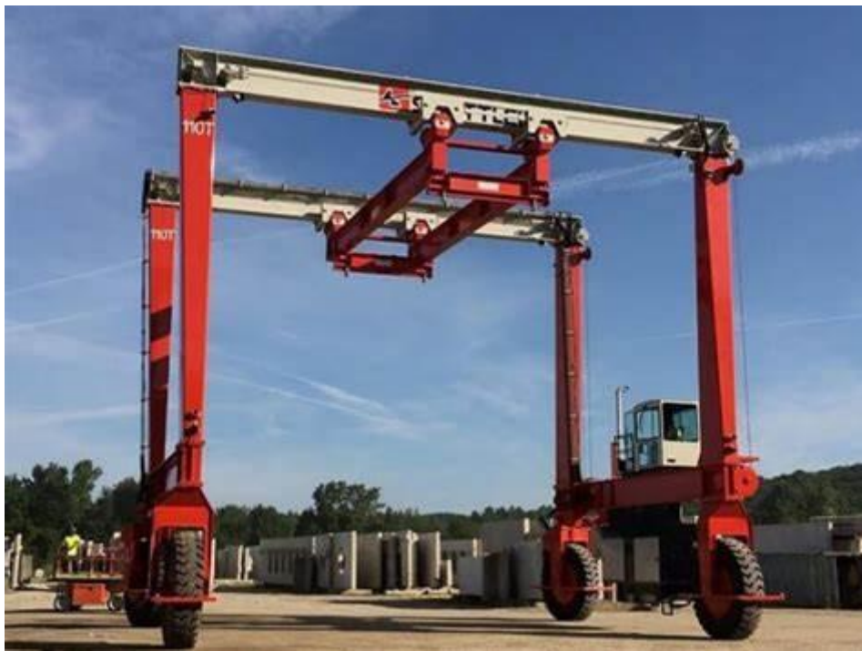
Figura 59, Selección del transporte, puente grúa móvil.
