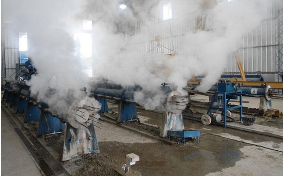
Figura 38, Proceso de curado por vapor.
