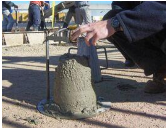
Figura 62, Ensayo de hormigón húmedo.
