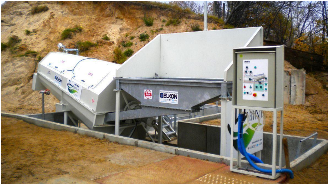
Figura 61, recicladora de hormigón húmedo, incluida en la planta de hormigón.
