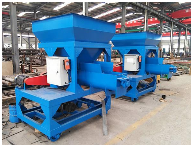
Figura 44, Unidad dosificadora de hormigón.
