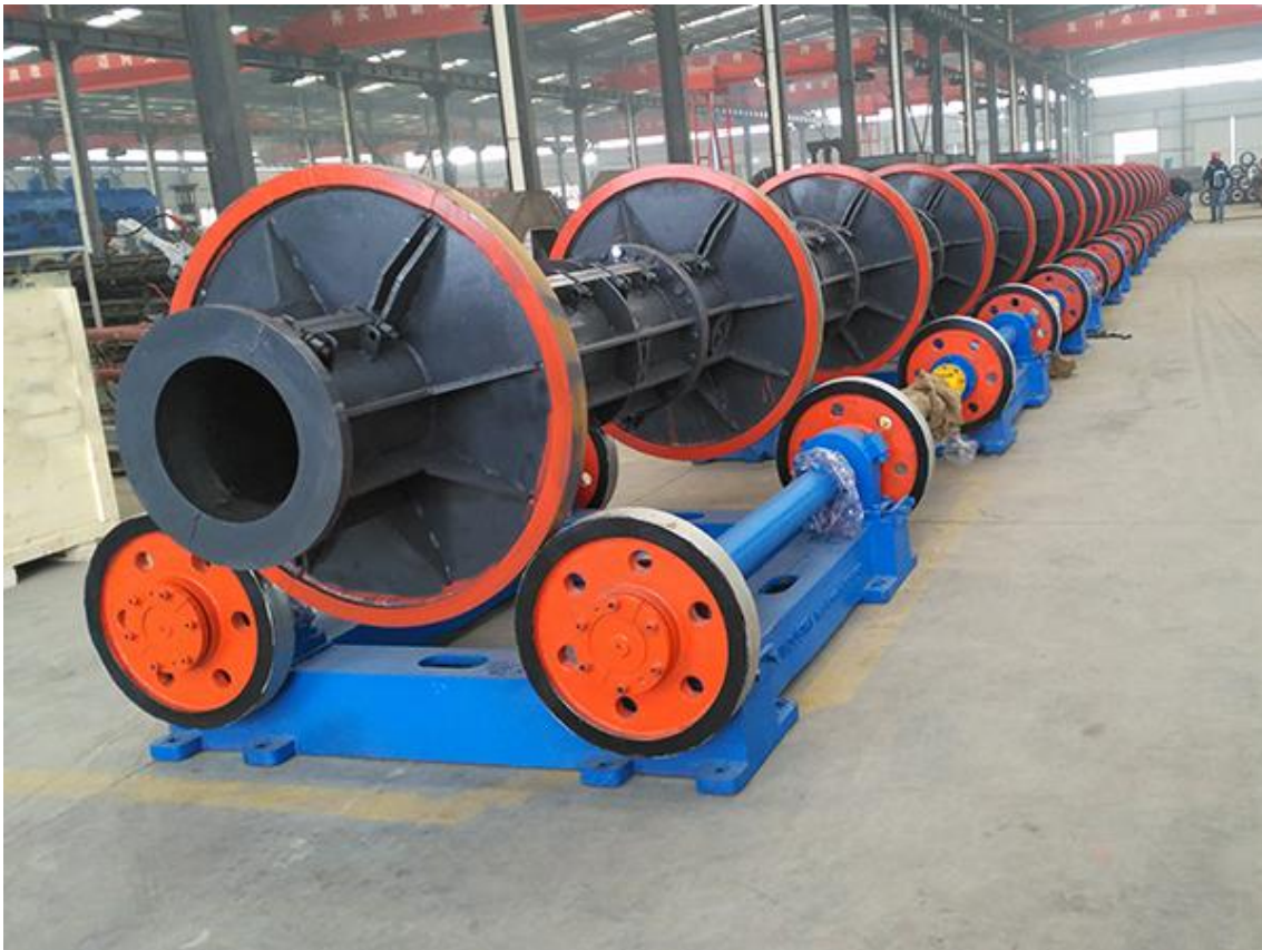
Figura 48, Centrifugadora de postes.
