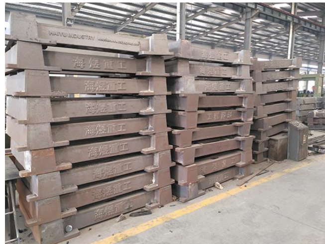
Figura 50, Fundación de acero forjado
