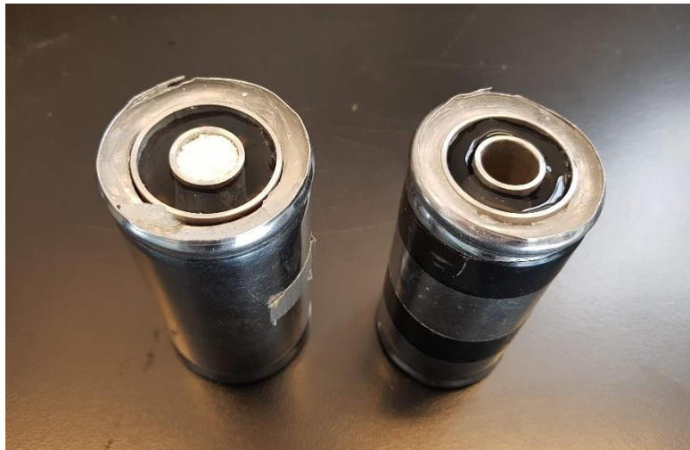
Figura IV. 1. UAET con PCM y agua (izq.), y la UAETb solo agua (der.).
