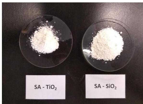
Figura III. 9. PCM obtenidos de partículas de SA/TiO 2 y SA/SiO 2 .
