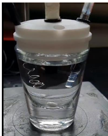
Ilustración 2. Modelo de Celda Electroquímica usada. Imagen de elaboración propia.
