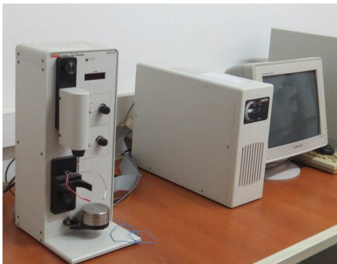
Ilustración 7. Potenciostato Comercial Epsilon 2/RDE 2 de la Universidad Nacional del Sur e INQUISUR. Imagen de elaboración propia.
