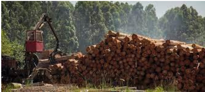
Fig. 11 imagen ilustrativa de cómo no deben acopiarse, todos juntos, los rollizos, madera etc.
