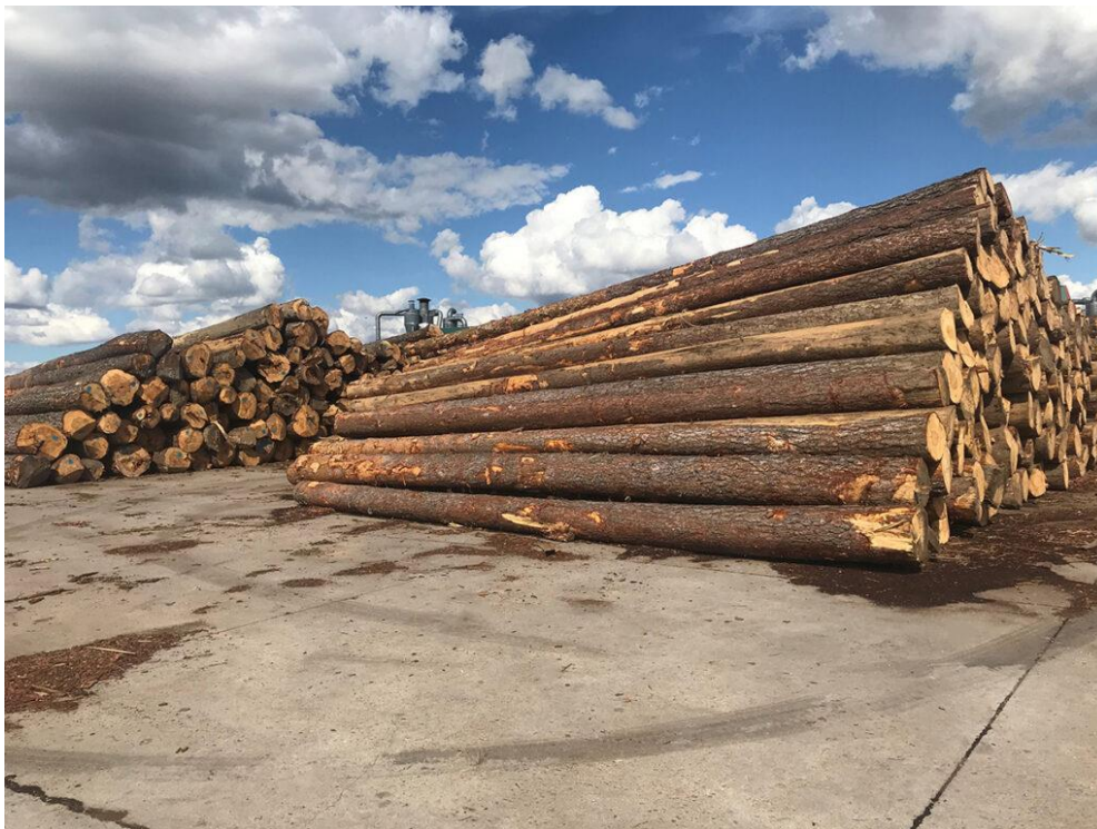
Fig. 12 Imagen ilustrativa de como debe acopiarse por sectores el material combustible para evitar el fuego fuera de control. También ayuda mucho la sectorización en la actuación de extinción.
