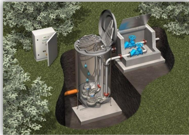
Ilustración 101- Pozo de bombeo
