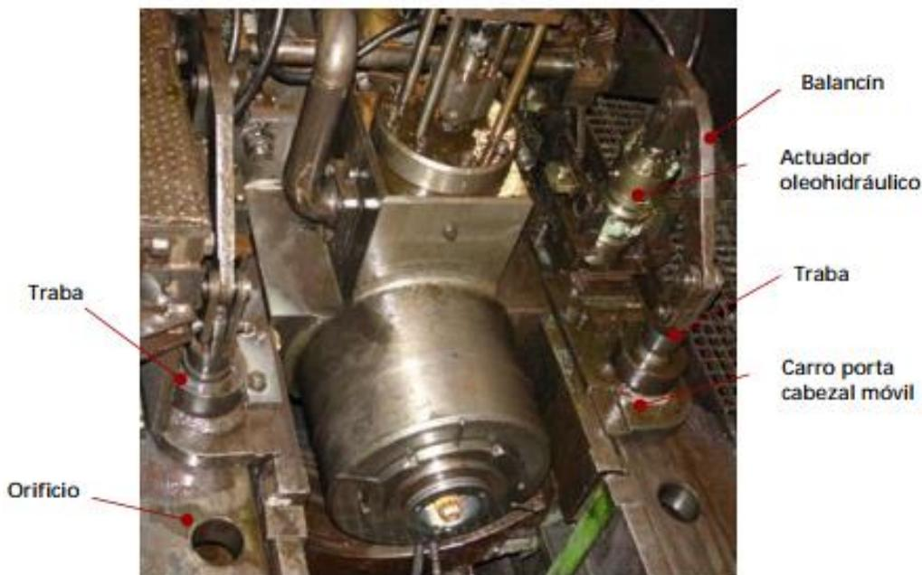
Estas trabas encastran en agujeros realizados sobre el bastidor de la maquina cada 60 centímetros, por lo que pueden ir enclavándose para probar diferentes medidas de tubos. Estos enclavamientos están realizados a la misma medida que la ubicación teórica de los sensores inductivos con los que se miden actualmente la longitud de los tubos a probar.
