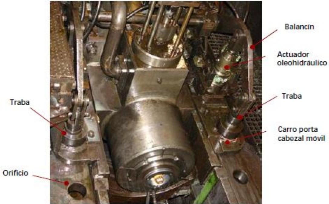
El abastecimiento de caudal y presión necesaria para realizar todos los movimientos deseados del carro porta cabezal móvil es abastecida mediante una unidad oleo hidráulica que se encuentra montada en la parte superior del carro.
