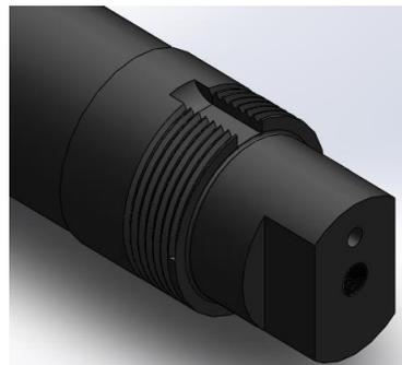
Si bien la tabla corresponde a un eje con chavetero, mientras que en nuestro diseño no contamos con chaveta, si poseemos un concentrador de tensiones, con características similares a un chavetero. La ranura corresponde a una guía de la arandela MB, cuya función es evitar que la tuerca KM se gire.
