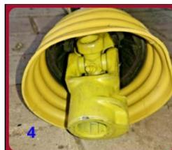
5. **Largo del cardan:** El largo del cardan lo determina la distancia entre las punteras estriadas de acople, es decir la distancia de la toma de fuerza a la conexión de la máquina agrícola.
