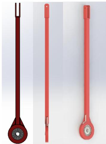
En primer lugar, se realiza el cálculo de la sección mínima del perno conector, el cual se encarga de conectar la biela superior con la inferior. Además de soportar el esfuerzo, también funciona de fusible en caso de que el sistema se atasque.
