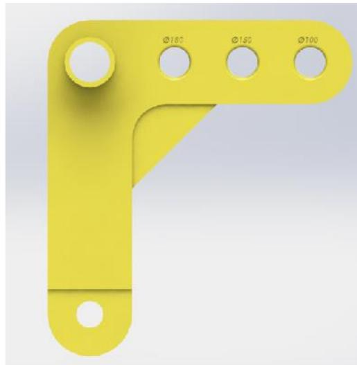
Como puede observarse en la imagen, en uno de los extremos o brazos de la rótula se encuentran perforaciones diseñadas para sujetar el cable que se conecta al árbol. Estas perforaciones están ubicadas a una distancia específica entre sí y con respecto al eje de giro de la biela. El objetivo de esta distancia es abarcar las frecuencias de sacudida necesarias para desprender las nueces de las ramas del árbol.
