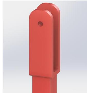
Diseño del conector de la biela
