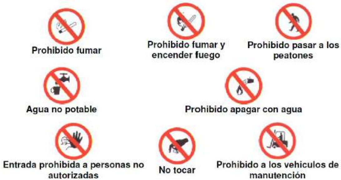
Imagen A1.1 – Señales de prohibición
