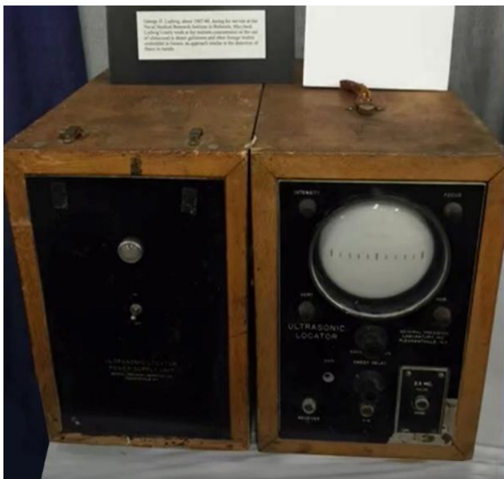
Ilustración 30 Primer equipo de ultrasónico creado por el Dr. George Ludwig
