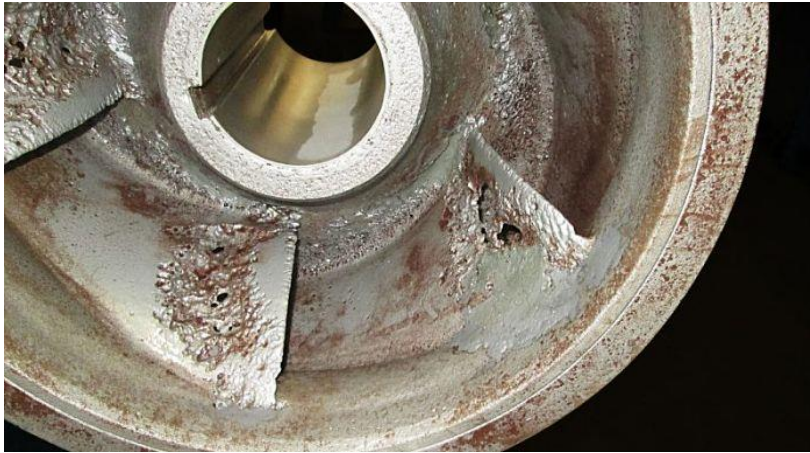
Figura 28: Daños por cavitación en los impulsores.
