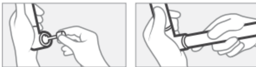
Figura 60: Montaje de tubos PVC.
