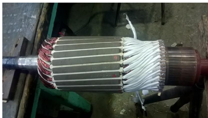
Figura 7. Inducido del motor de traslación rebobinado.
