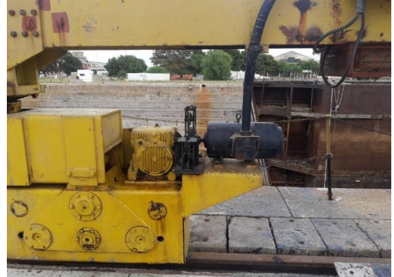
Figura 4. Motor de traslación
