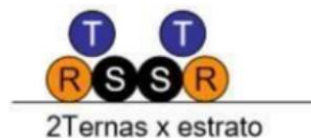
Figura 35. Montaje de los cables Unipolares
