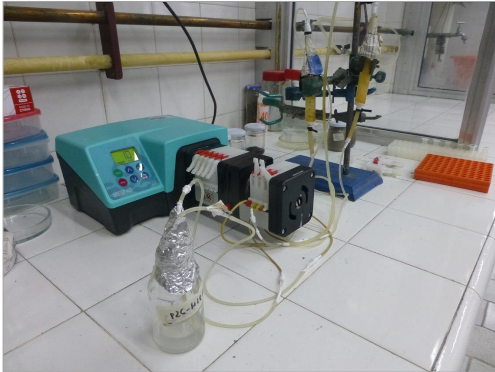
Foto 2-5. Vista del sistema integrado por la bomba multicanal, frasco con mezcla de hidrocarburos y reactores con co-cultivo P26-H19 inmovilizado.
