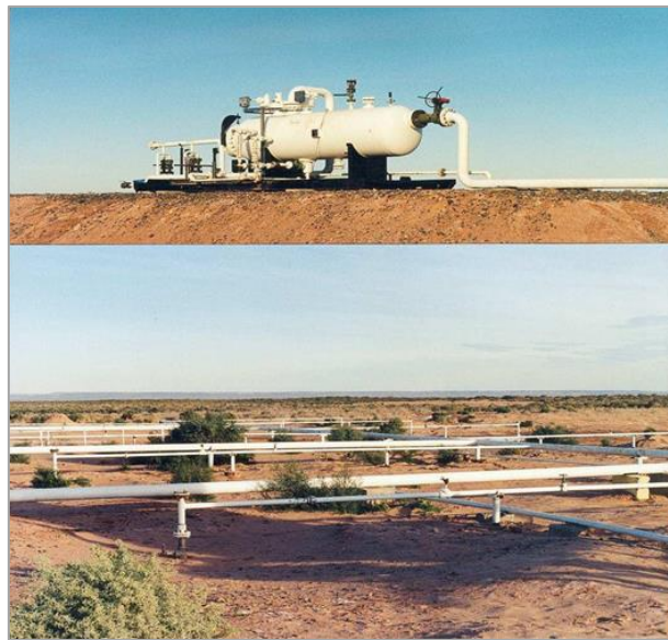
Foto 1-3. Dispositivo utilizado para la remediación de napa freática (Bioslurping) ubicada entre 1-5 m de profundidad y contaminada con gasolina que ocupó 13 hectáreas en el bajo de Añelo, Neuquén (Mendoza 2018).
