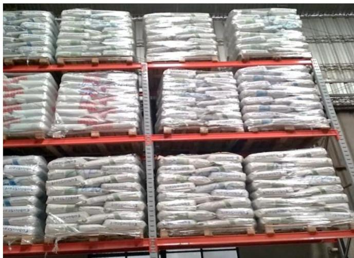
Figura 1:5: Disposición de las bolsas sobre los pallets. Imagen tomada en Insuquim S.A.
