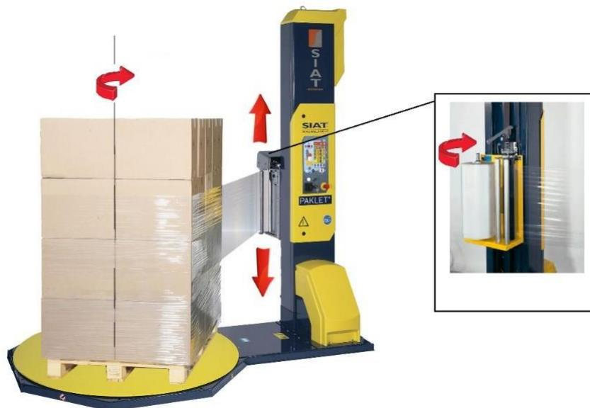
Figura 1:2: Movimientos de las partes del equipo. Elaboración propia.
