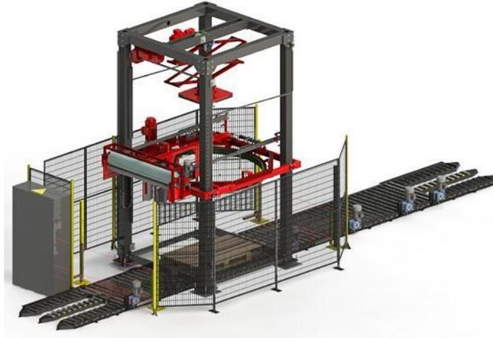
*Figura 2:2: Representación de envolvedora de pallets automática de anillo rotativo RRM6500. EAR- FLAP GROUP. Copyright 2017. Reimpreso con permiso.*
