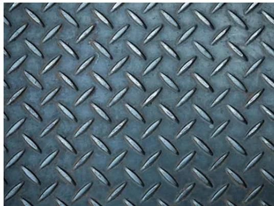
Figura 3:4: Chapa semilla de melón o "Chapa semillada" espesor 3/16". Mercado Libre. Copyright 1999. Reimpreso con permiso.
