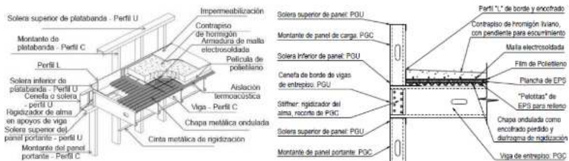
– imagen 59: Cubierta plana. (ConsulSteel, 2002)
