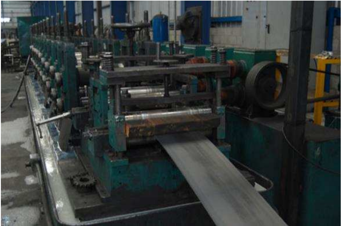
– imagen 71: maquina industrial de conformado de perfiles
