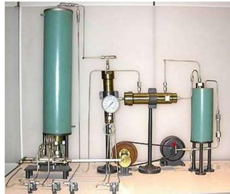
El proceso de Haber-Bosch consiste en la síntesis de amoníaco a partir de nitrógeno e hidrógeno, en condiciones de elevada presión (200 atm) y elevada temperatura (450-500°C).
