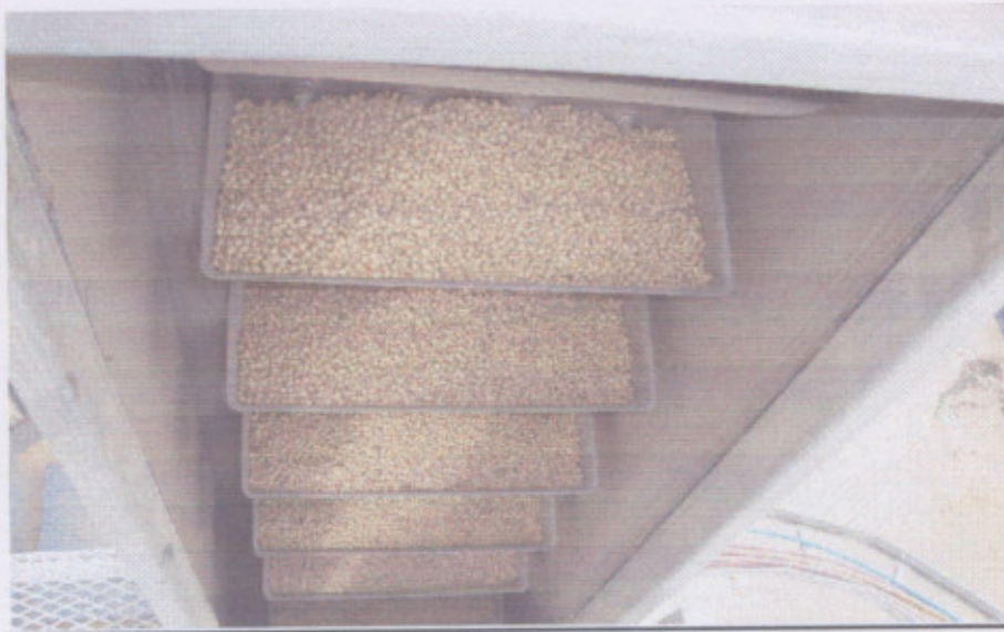
Fig.83- Elevador a cangilones-Cangilones cargados
