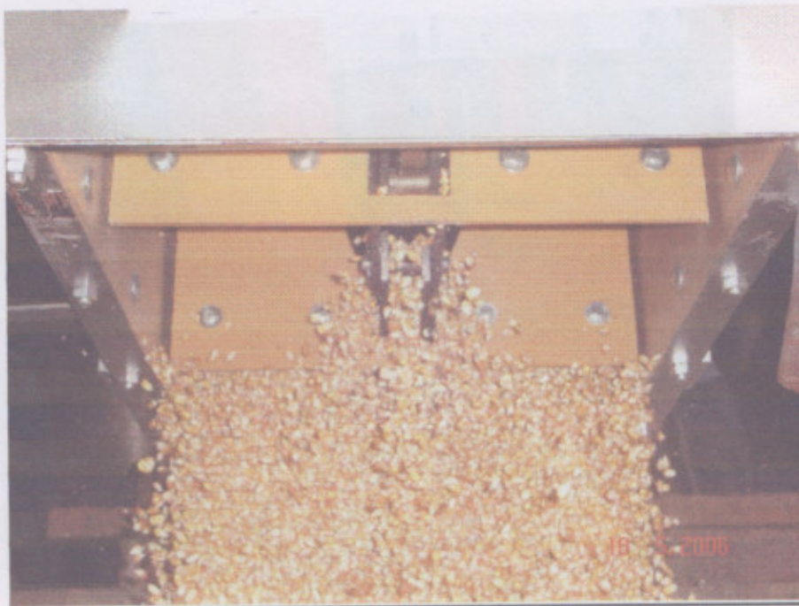
Fig.90- Redler– Cadena de arrastre con paletas de plástico
