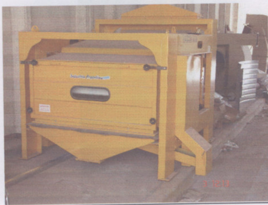
Fig. 63-Limpiadora de granos-Salidas de cereal limpio e impurezas finas y gruesas
