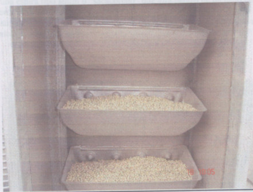
Fig.84- Elevador a cangilones-Cangilones cargados
