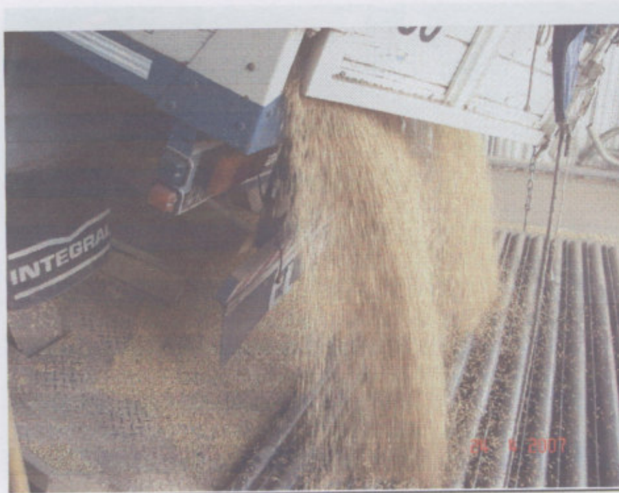
Fig. 30 -Rejilla de Tolva - Acoplado en plena descarga
