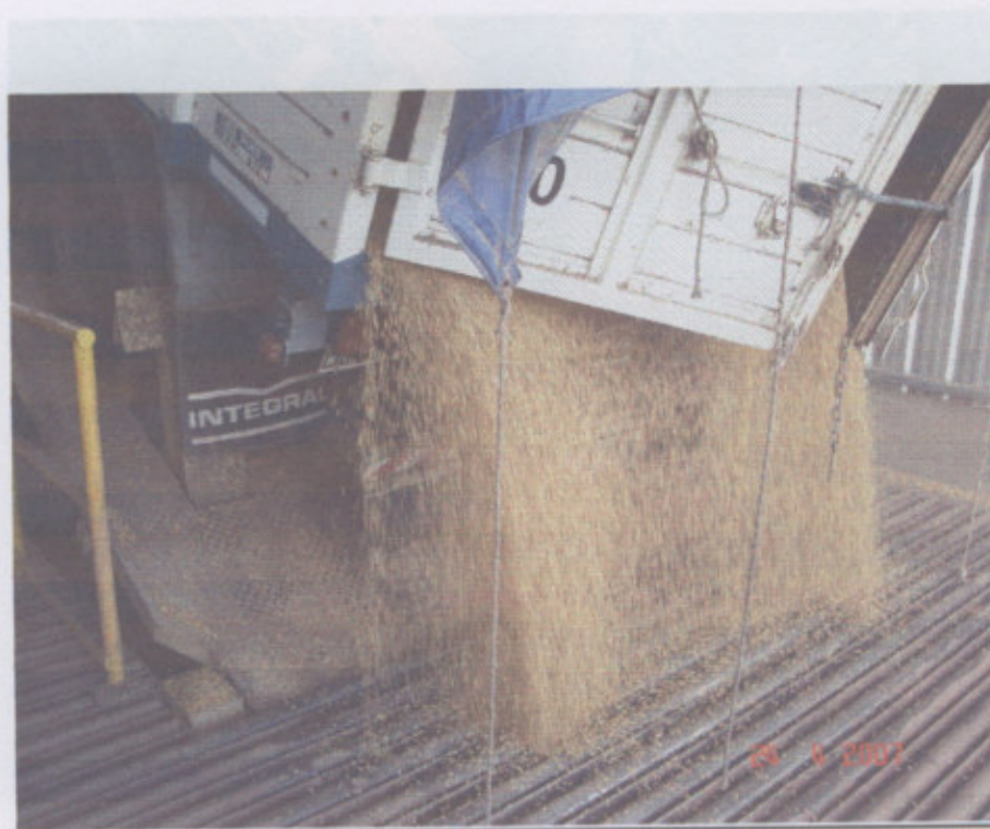
Fig. 31 -Rejilla de Tolva - Acoplado en plena descarga
