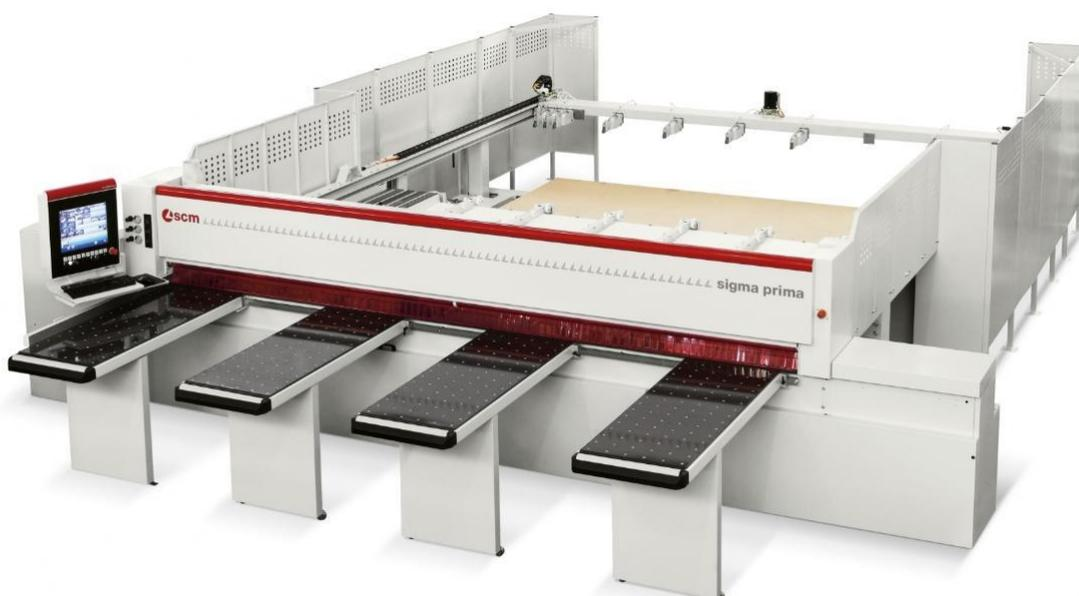
Imagen 1 Seccionadora Horizontal
