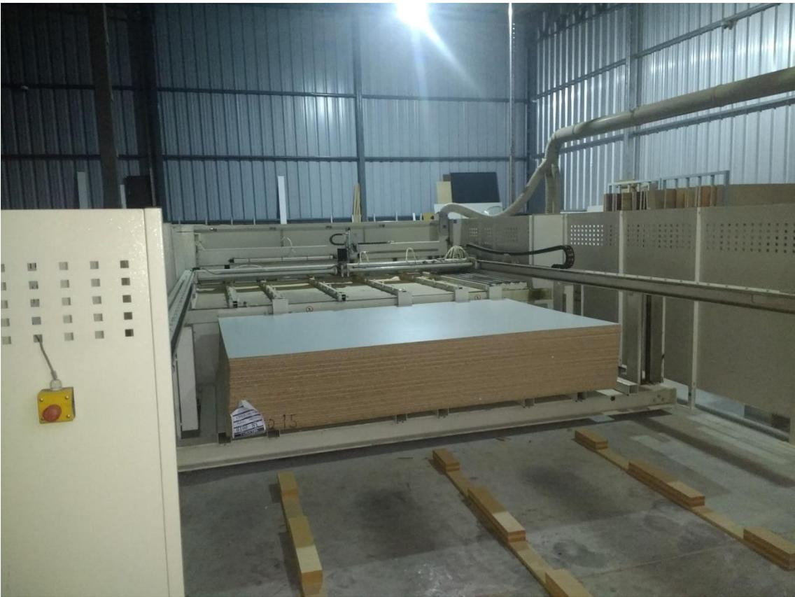
Foto 18 Cargado de placas para ser cortadas
