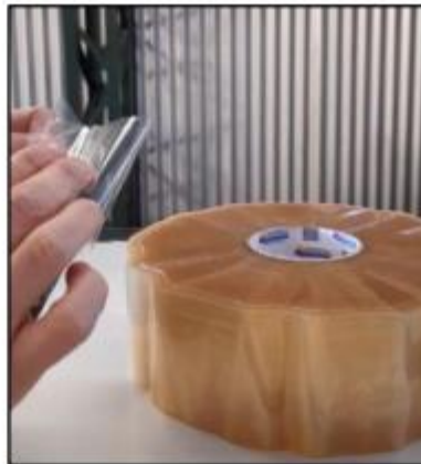
Insumo Cinta doblado enfrentando las caras con adhesivo
